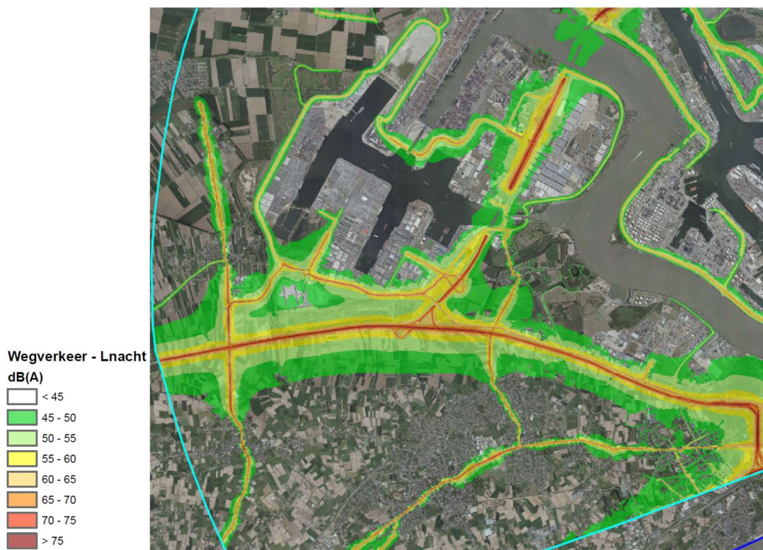
Figuur 3-51: Gewogen gemiddelde geluidsbelasting (Lnacht) voor het havengebied - wegverkeer, spoorverkeer en industrie (bron: Havenbedrijf Antwerpen: 'Geluidskaarten tweede versie' - havengebied Antwerpen', overgenomen uit het MER ECA.
