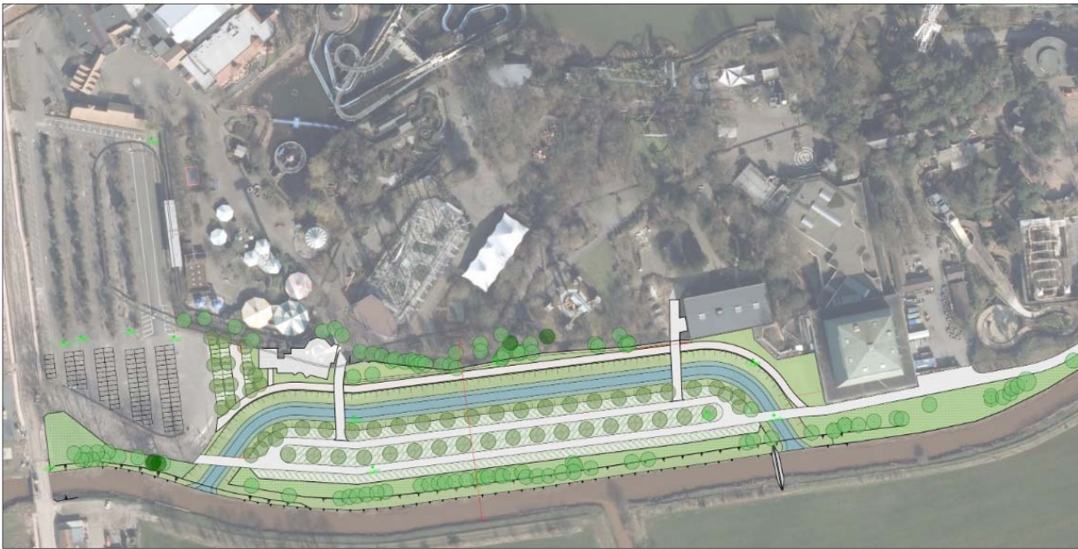
Figuur 14. Ontwerpend onderzoek Building with Nature (inrichting parking met overstromingsfunctie Bobbejaanland) (Cluster i.o.v. VMM)
