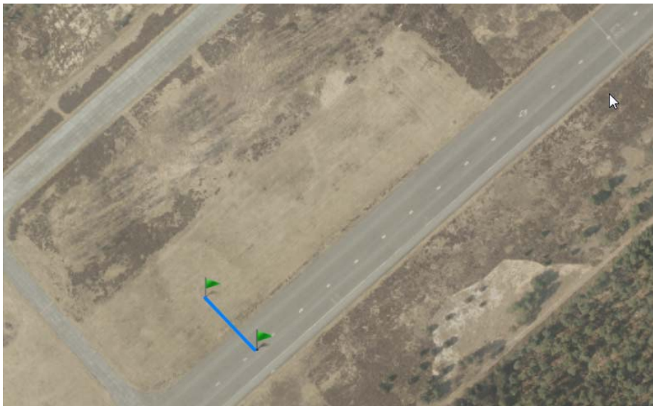
Illustratie 17.32: Overlapzone tussen de 620 m zweefbaan (gras) en de 920 m motorbaan (beton) met aanduiding 60 m tussen beide groene vlagjes
