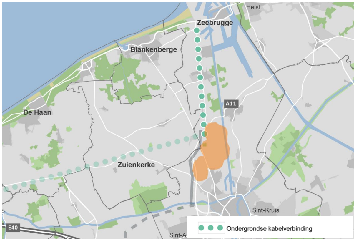
Figuur 5-6: Indicatieve aanduiding van een mogelijke ondergrondse verbinding tussen bestaande station Stevin en de mogelijke zone voor postlocatie in Noord-Brugge
