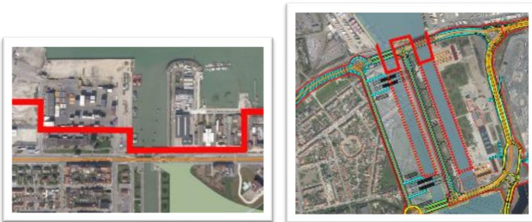
Figuur 5.19: Contouren maatregelen tegen overstroming (links: t.h.v. Visartsluis – rechts t.h.v. Vandammesluis en nieuwe zeesluis) (Tractebel, 2016 k)
