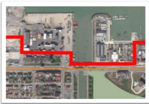
Figuur 5.14: Contouren maatregelen tegen overstroming (links: t.h.v. Visartsluis – rechts t.h.v. Vandammesluis en nieuwe zeesluis) (Tractebel, 2016 d)
