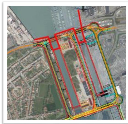
Figuur 5.14: Contouren maatregelen tegen overstroming (links: t.h.v. Visartsluis – rechts t.h.v. Vandammesluis en nieuwe zeesluis) (Tractebel, 2016 d)
