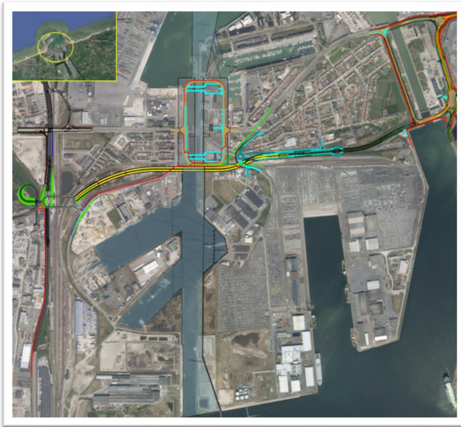
fig. 5 – Alternatief Visart oost, NX in tunnel
