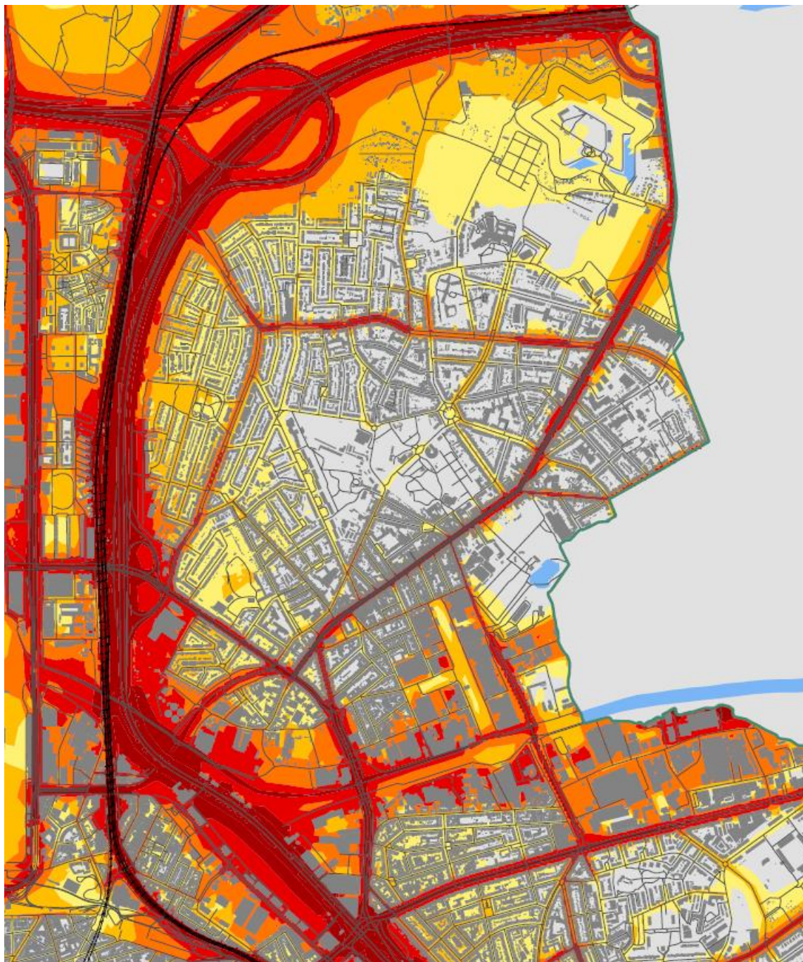
Kaart 9c - Detail Merksem en Antwerpen Luchtbal - Strategische geluidsbelastingskaart agglomeratie Antwerpen. Alle bronnen. Parameter: L_{den}
