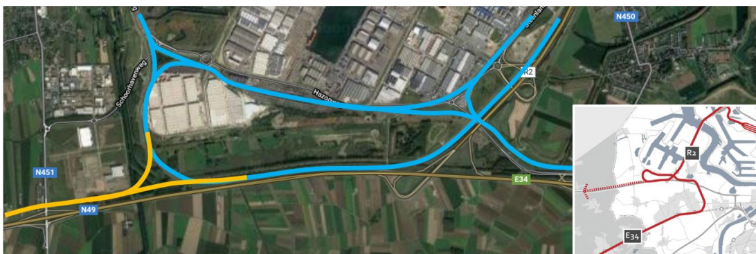
Figuur 4-7: Verlenging goederenspoorlijn Gent-Antwerpen langs E34 (obv Ontwerp-Routeplan 2030) met uitsnede Ontwerp-Routeplan 2030 (blauw: bestaande spoorlijn L10)
