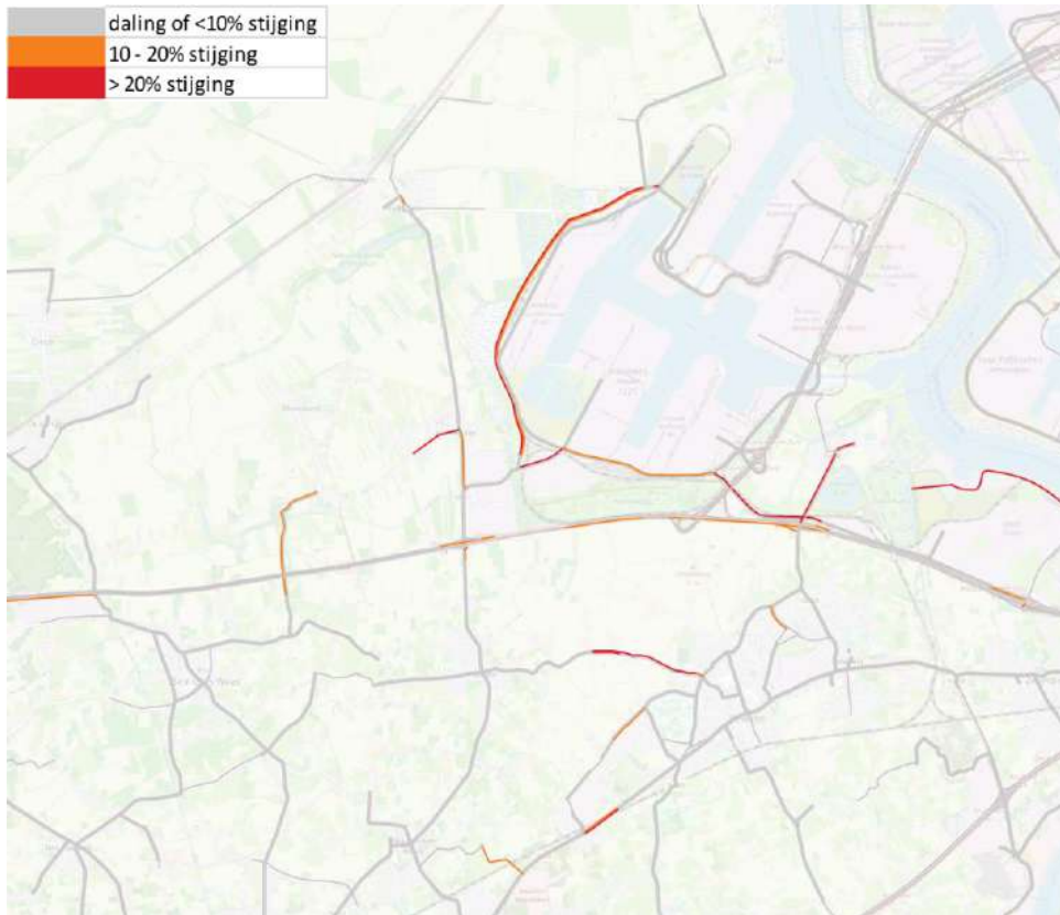
Figuur 6-56 %-toename verkeersvolume binnen studiegebied tussen alle aansluitingsvarianten ontwikkelingsscenario verbindingsweg E34-N70 en de ref. toestand – dagdeel ASP (16u-19u)
