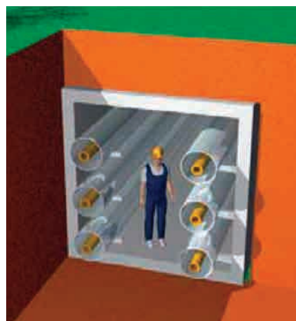
↑ Figuur 15 Doorsnede van een GIL-tunnel
