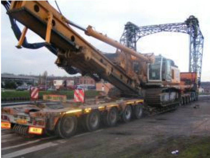
Figuur 4: Dieplader met boorpaalmachine
