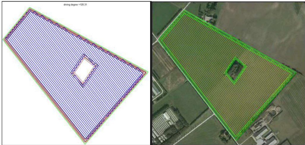
Figuur 5. Geometrische voorstelling en visualisatie van de routeplanning voor een perceel met een obstakel. Rondom het obstakel worden extra omkeerpunten noodzakelijk en hierdoor wordt deze zone een nieuwe kopakker (Zhou, 2015).
