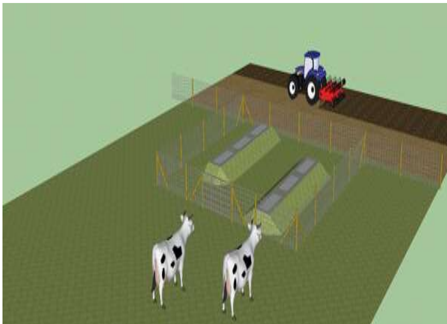
Figuur 3: Inspectieputten/transitieputten ondergrondse hoogspanningslijnen ter hoogte van verbinding opeenvolgende kabels bij het Stevin-traject (Stevin, z.d.-a)
