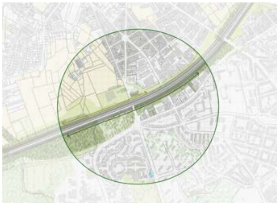
Figuur 393: G3A3 – N290 – knelpunt inzake langse ecoconnectiviteit door aanwezigheid laterale infrastructuur aan binnenzijde R0
