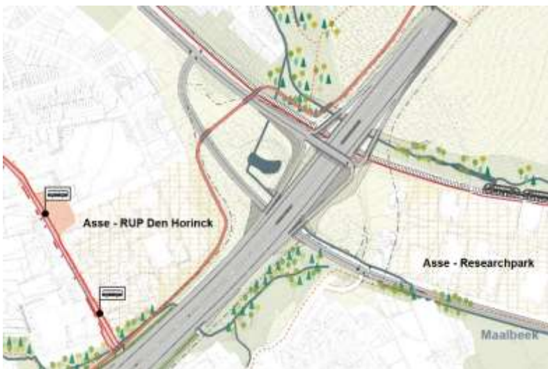
Figuur 40: ASC10 (Zellik) als Hollands complex over R0 (illustratie voor alternatief 1)
