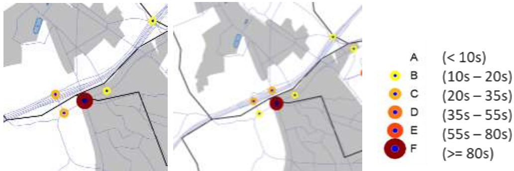
Figuur 88: LOS-waarden op de kruispunten – alternatief 2a': links het alternatief, rechts de variant ASC 9b OSP.
