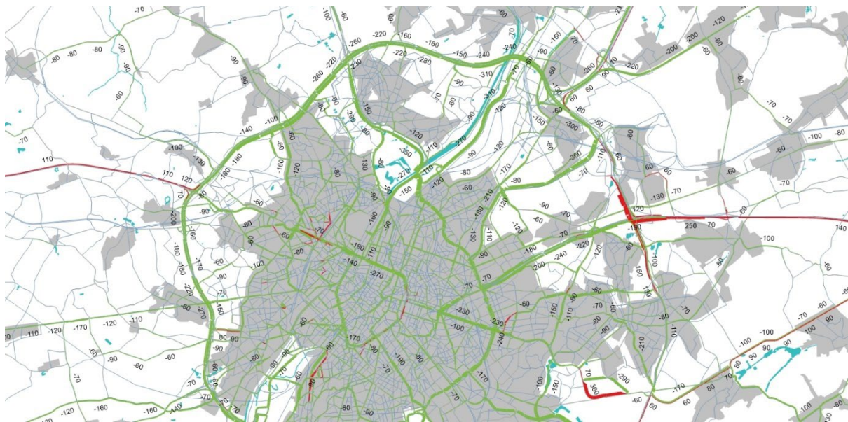
Figuur 9: Update: Verschillenplot ochtendspits combinatie 1b met AMS, vergeleken met combinatie 1b zonder AMS (bron: RVM RND v4.2.1)
