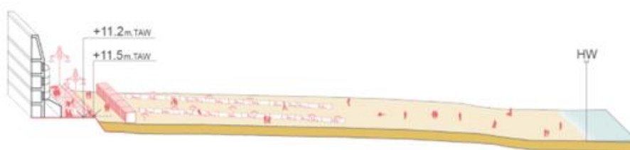
Figuur 3-14: Voorbeelduitwerking t.h.v. De Haan in alternatief 'Ter plaatse' bij +2m zeespiegelstijging en variant dijk
