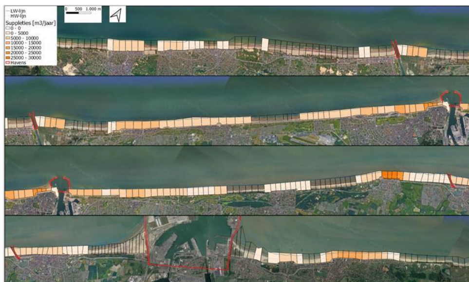
Figuur 6-8: Overzicht van de (totale) gemiddelde suppletiehoeveelheden (m 3 /jaar) per kustsectie langsheen de kust (Consortium Hoogtij(d) (IMDC, ORG, Arcadis), 2023d)
