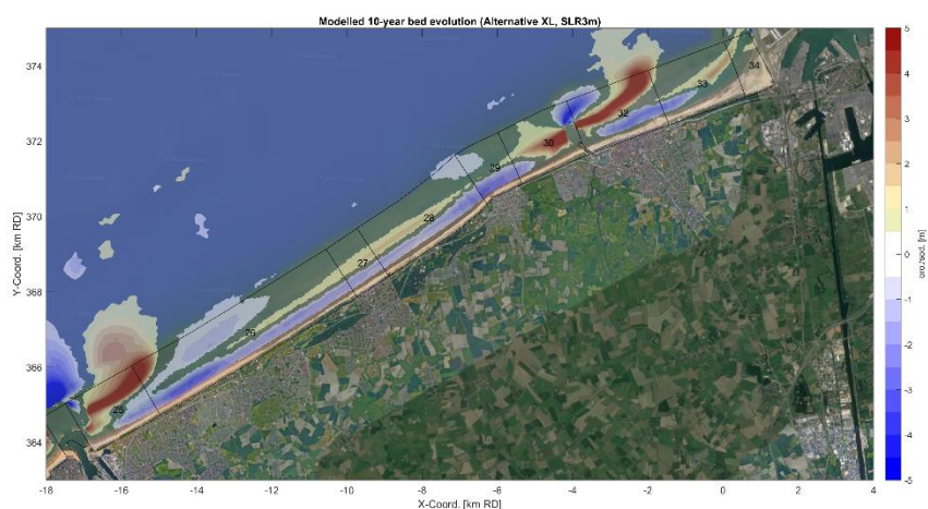
Figuur 7-12: Erosie/ sedimentatie na 10 jaar morfologische ontwikkeling (in respectievelijk blauwe en rode kleur) in het gebied tussen Oostende en Zeebrugge voor geoptimaliseerd alternatief L (boven) en L in combinatie met zeevaartse uitbreiding havendammen voor zeeluisen in Oostende en Blankenberge (onder) bij 3 m zeespiegelstijging.
