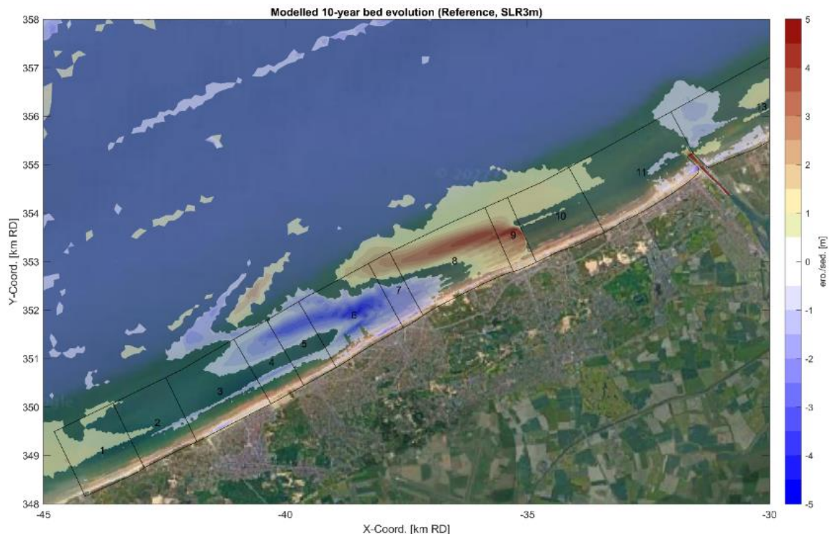
Figuur 7-4 Erosie/ sedimentatie na 10 jaar morfologische ontwikkeling (in respectievelijk blauwe en rode kleur) voor de Westkust voor de referentieberekening (bij 3 m ZSS).
