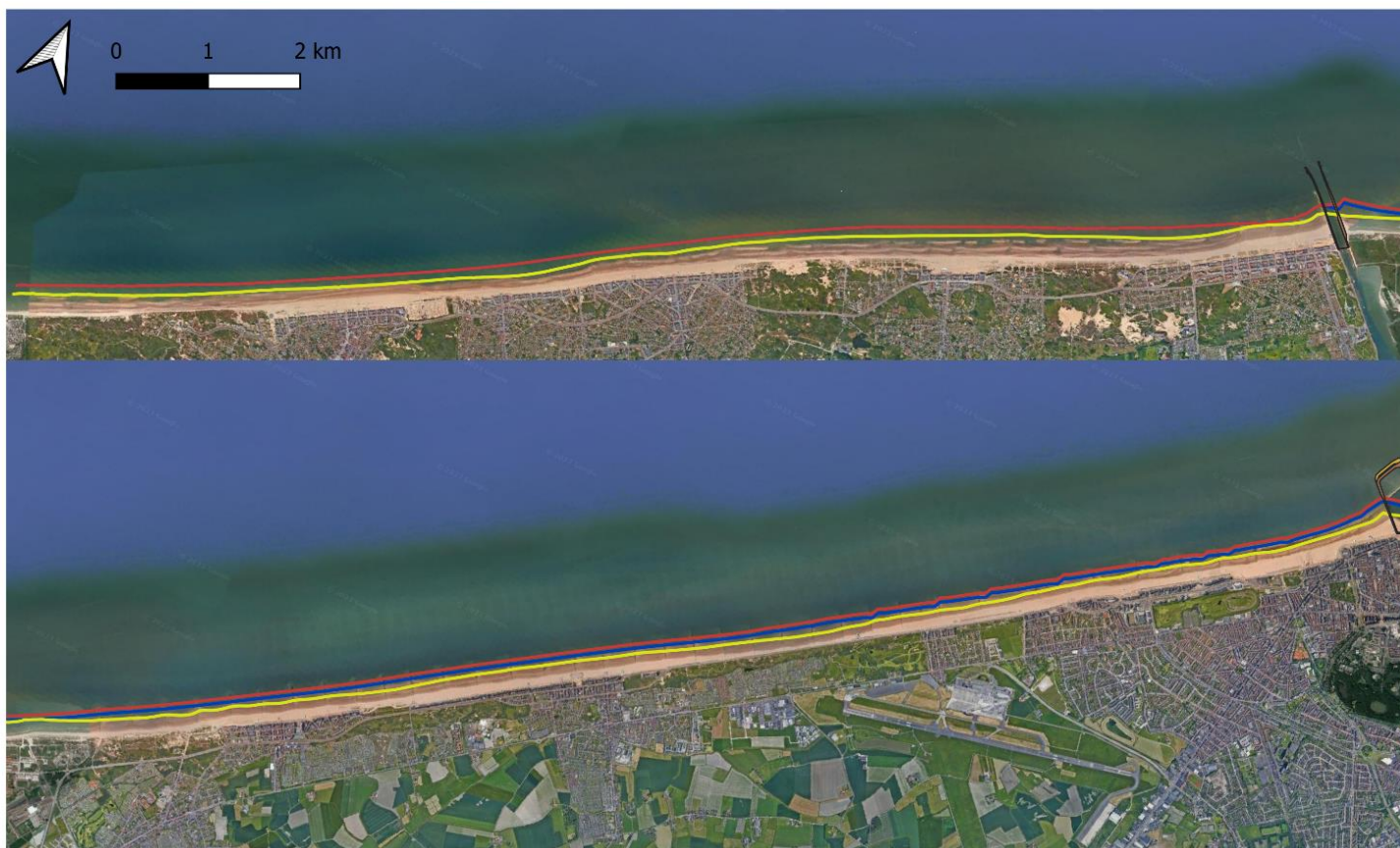
Figuur 4-3: Kustlijnpositie voor geoptimaliseerde alternatieven S (geel), M (blauw) en L (rood) voor +3 m ZSS, voor Franse grens – Haven van Nieuwpoort (boven) en Haven van Nieuwpoort – Haven van Oostende (onder).
