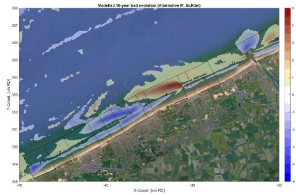
Figuur 7-5: Erosie/ sedimentatie na 10 jaar morfologische ontwikkeling (in respectievelijk blauwe en rode kleur) voor de Westkust voor de referentieberekening (linksboven) en geoptimaliseerde alternatieven S (rechtsboven), M (linksonder) en L (rechtsonder) bij 3 m zeespiegelstijging.
