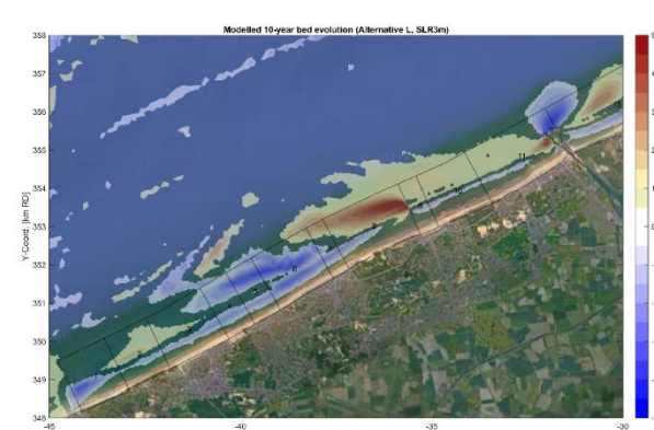
Figuur 7-5: Erosie/ sedimentatie na 10 jaar morfologische ontwikkeling (in respectievelijk blauwe en rode kleur) voor de Westkust voor de referentieberekening (linksboven) en geoptimaliseerde alternatieven S (rechtsboven), M (linksonder) en L (rechtsonder) bij 3 m zeespiegelstijging.
