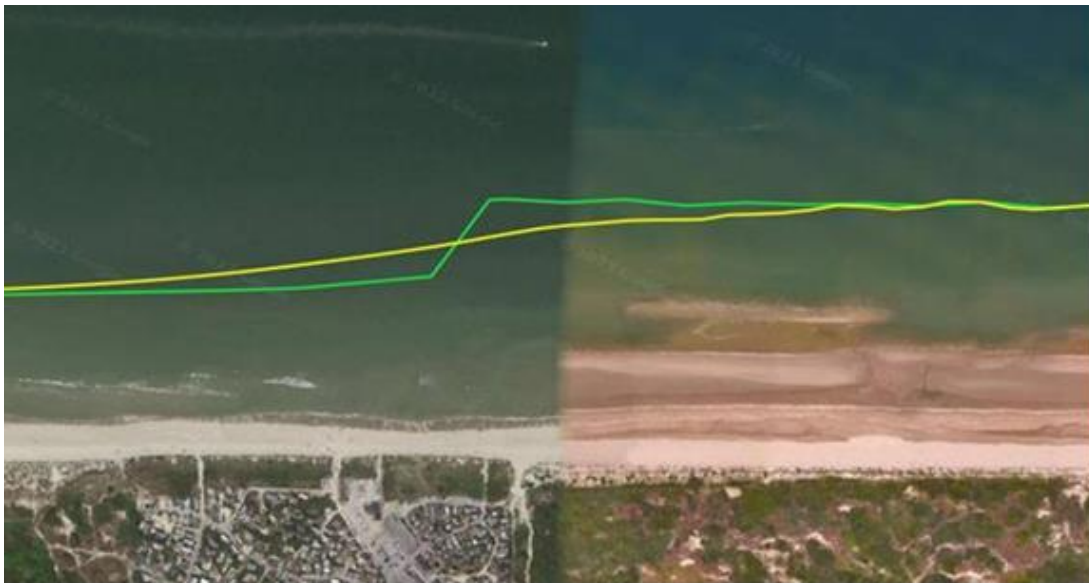
Figuur 4-5: Initiële (groen) en finale (na 5 jaar, geel) kustlijn voor de gesimuleerde overgang, geen aanpassingen in Frankrijk naar Alternatief L, ter hoogte van de Franse grens.
