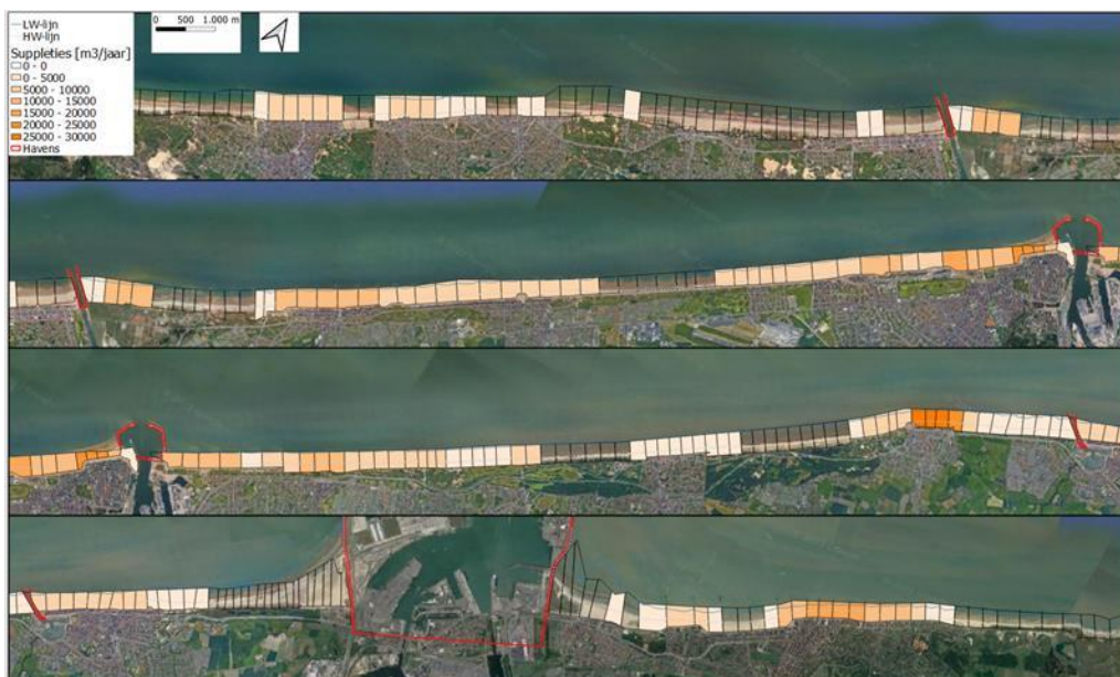
Figuur 9-6: Overzicht van de (totale) gemiddelde suppletiehoeveelheden (m 3 /jaar) per kustsectie langsheen de kust. Opgesteld voor de kustlijnmodellering in (Consortium Hoogtij(d) (IMDC, ORG, Arcadis), 2022b).
