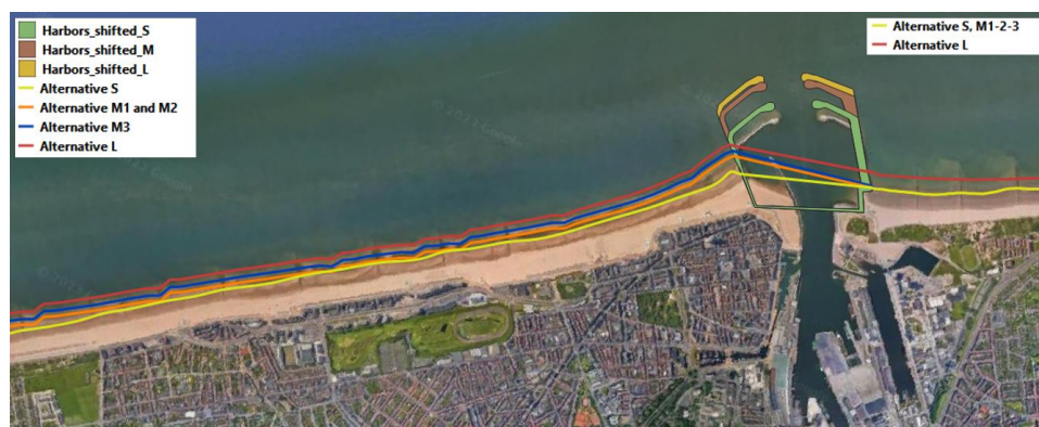
Figuur 4-12: Positie van de kustlijn voor de geoptimaliseerde alternatieven S, M en L, ter hoogte van de haven van Oostende, voor alle zeespiegelstijgingen (+1, 2 en 3 m).
