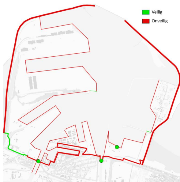
Figuur 4-17 : Veiligheidsscan resultaten voor haven van Zeebrugge voor +1 m zeespiegelstijging (dunne lijn geeft de waterkant of kade weer, ter hoogte van de dikke lijn ligt de zeeweringscontour in de haven, hydraulische structuren zijn weergegeven als bollen).
