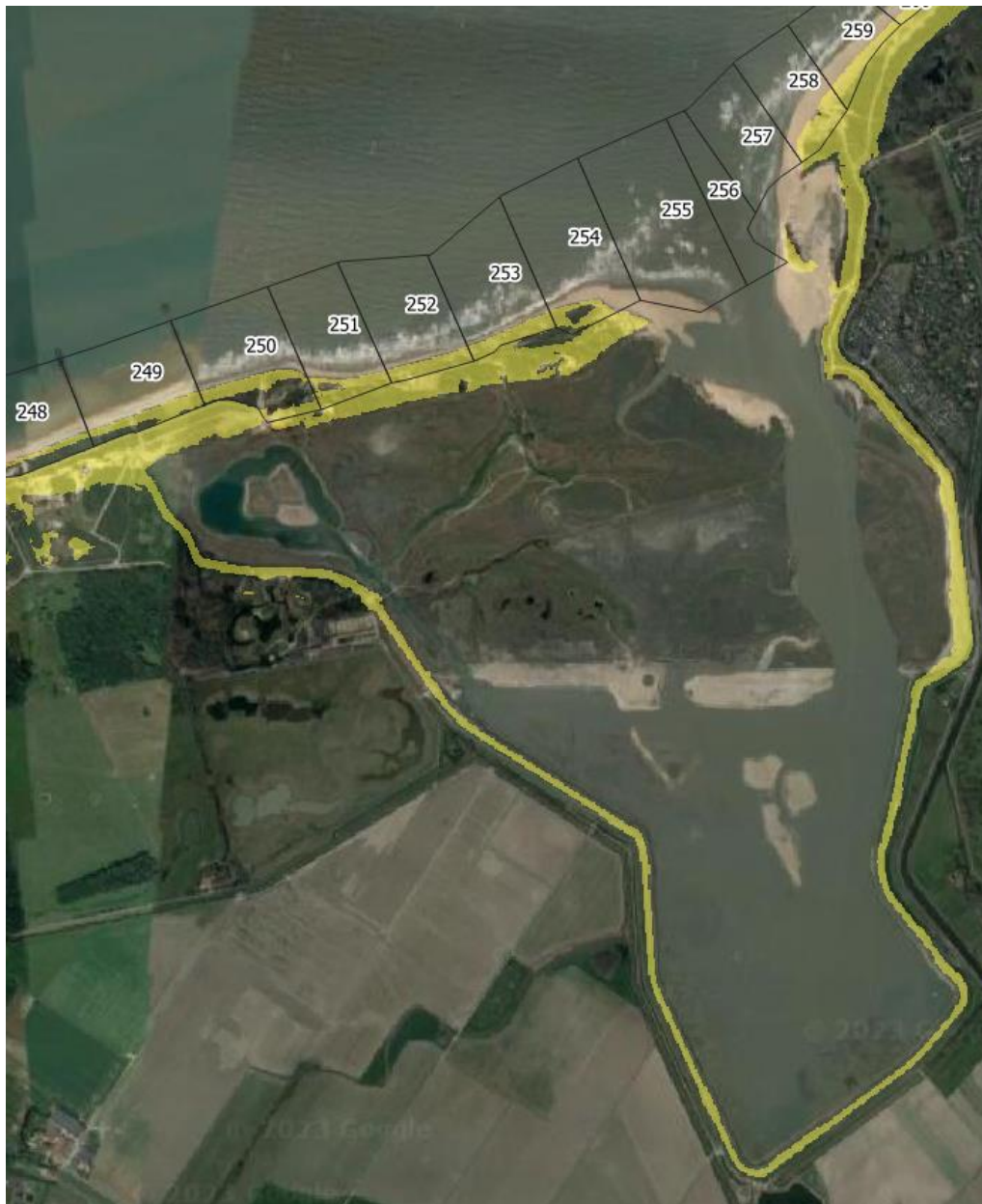
Figuur 3-11: Overzicht van het Zwin. De geel gekleurde gebieden hebben een hoogteligging hoger dan +8mTAW en geven aan hoe de Zwindijk rondom het gebied aansluit op de zeedijk ter hoogte van sectie 249.
