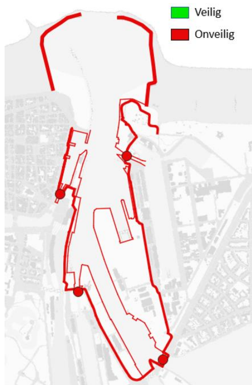
Figuur 4-42 : Veiligheidsscan resultaten voor haven van Oostende voor 3 m zeespiegelstijging (dunne lijn geeft de waterkant of kade weer, ter hoogte van de dikke lijn ligt de zeeveringscontour in de haven, hydraulische structuren zijn weergegeven als bollen).
