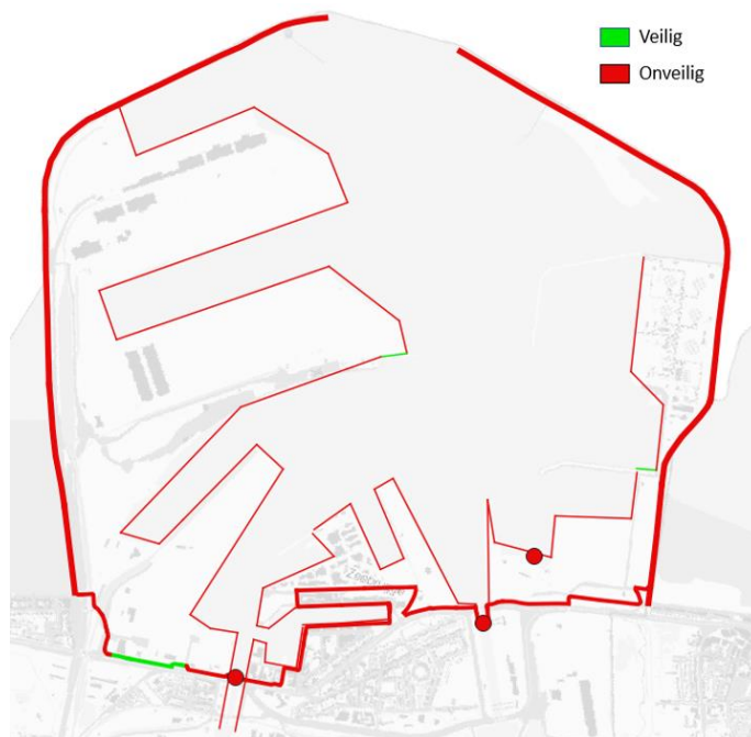
Figuur 4-48: Veiligheidsscan resultaten voor haven van Zeebrugge voor +3 m zeespiegelstijging (dunne lijn geeft de waterkant of kade weer, ter hoogte van de dikke lijn ligt de zeezuigingscontour in de haven, hydraulische structuren zijn weergegeven als bollen).
