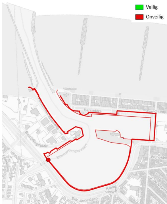
Figuur 4-29 : Veiligheidsscan resultaten voor haven van Blankenberge voor +2 m zeespiegelstijging (dunne lijn geeft de waterkant of kade weer, ter hoogte van de dikke lijn ligt de zeeweringscontour in de haven, hydraulische structuren zijn weergegeven als bollen).
