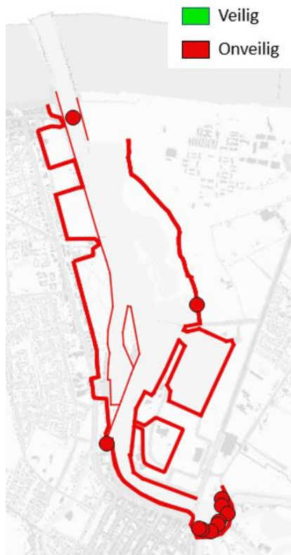
Figuur 4-38 : Veiligheidsscan resultaten voor haven van Nieuwpoort voor +3 m zeespiegelstijging (dunne lijn geeft de waterkant of kade weer, ter hoogte van de dikke lijn ligt de zeeveringscontour in de haven, hydraulische structuren zijn weergegeven als bollen).
