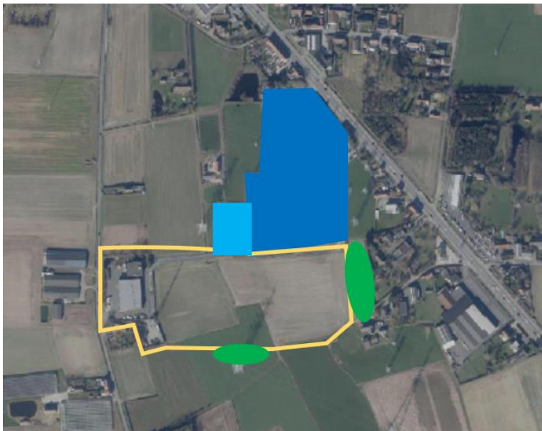
figuur 5-16: Schematische voorstelling hoogspanningsstation Izegem (uitbreiding: geel, bestaande infrastructuur: blauw (lichtblauw: te herbestemmen), gemengd openruimtegebied: groen)
