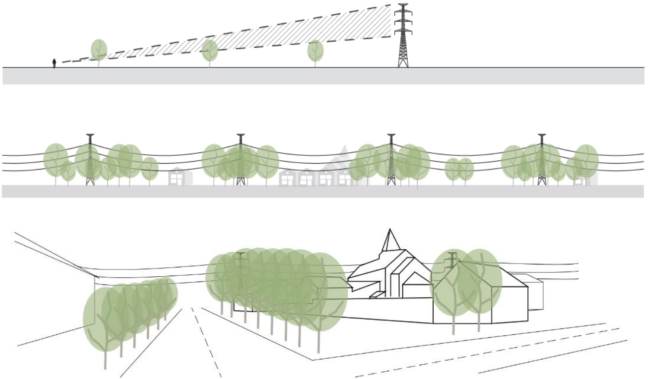
figuur 5-11: Schematische voorstelling visuele en landschappelijke inpassing van een hoogspanningsverbinding / bomen aanplanten op welgekozen locaties
