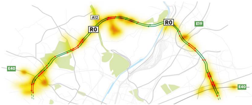
Figuur 22: Heatmap verkeersongevallen met de analyse van de discontinuïteiten en turbulentielengtes van de bestaande toestand op de DRW (120km/u)
