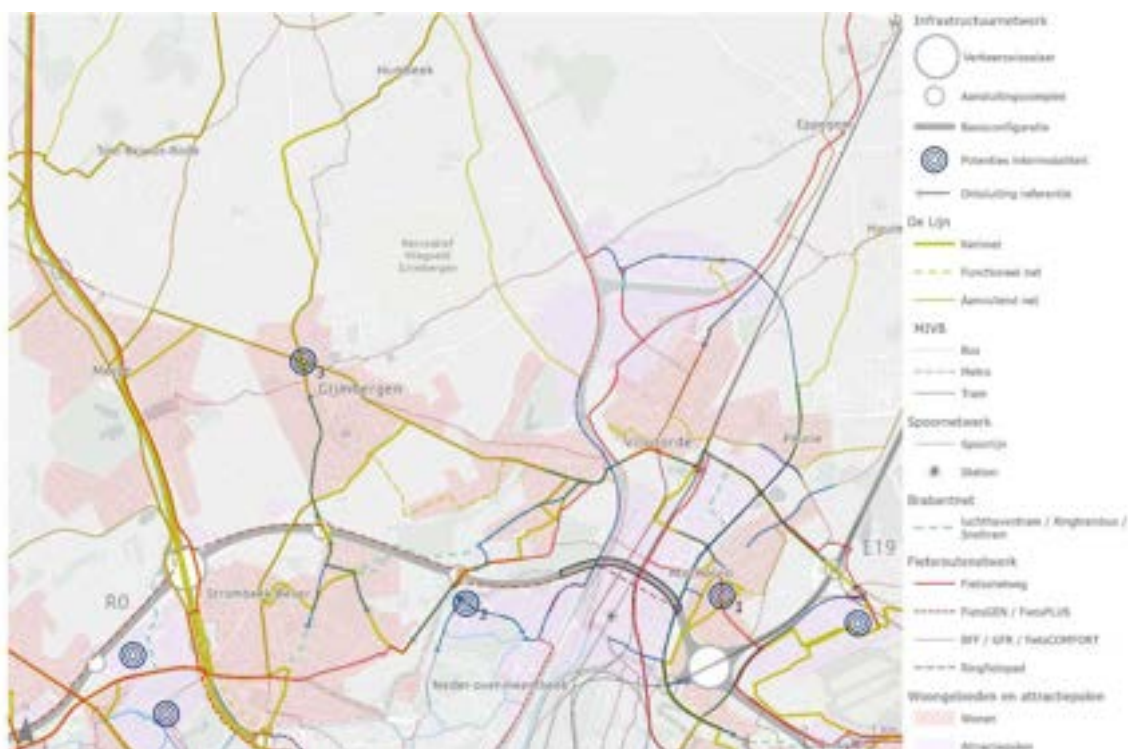
Figuur 163 Interactie tussen netwerken fiets, openbaar vervoer en ontsluiting naar hoofdwegennet – referentietoestand zone Vilvoorde
