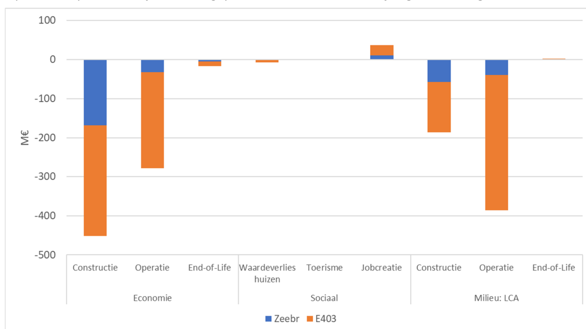
Figuur 27: Maatschappelijke kost/baat per type impact en per werktraject van het voorkeurstracé
