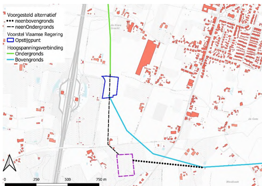
Figuur 22-18: ligging van een alternatieve locatie voor het opstijgpunt Izegem Zuid, zoals voorgesteld door de stad Izegem en de bijhorende alternatieve verbindingen (ondergronds = stippelijijn, bovengronds = bolletjeslijn)
