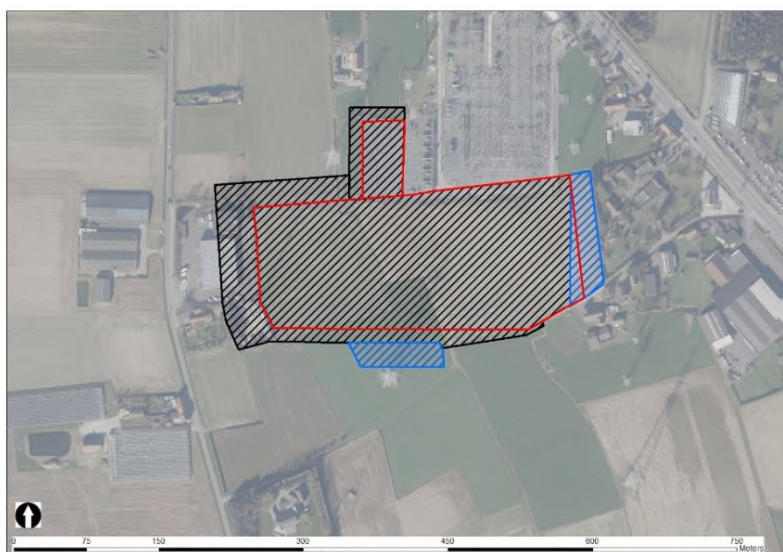
Figuur 3-3: contouren van de te herbestemmen zones voor het realiseren van het hoogspanningsstation Izegem zoals beoordeeld in stap 2 (rood) en geoptimaliseerde contouren (zwart), met zones voor waterberging (blauw)
