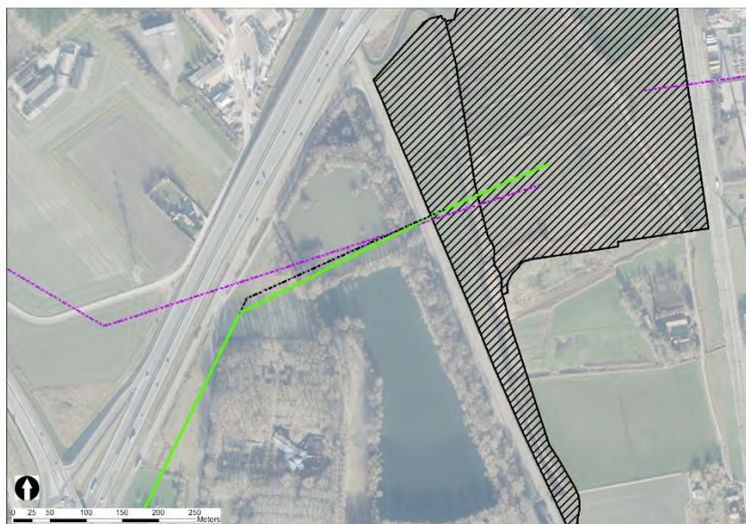
Figuur 21-2: ligging van het bovengrondse (groen) en ondergrondse (paarse stippellijn) tracé uit het voorontwerp GRUP en het aangepaste tracé (zwarte stippellijn)
