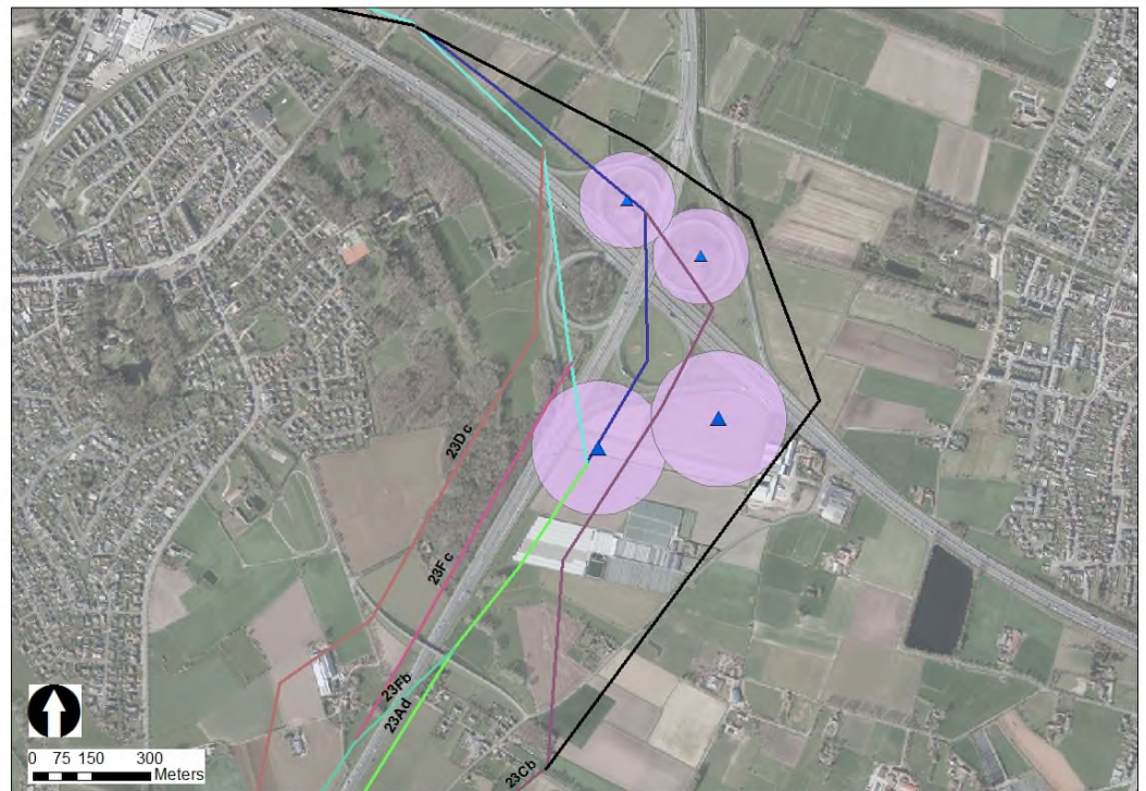
Figuur 2-40: zwart: mogelijke tracéwijziging ter hoogte van 22Bb en 23Cb, paars: 1,5x de rotordiameter rondom vergunde windturbines
