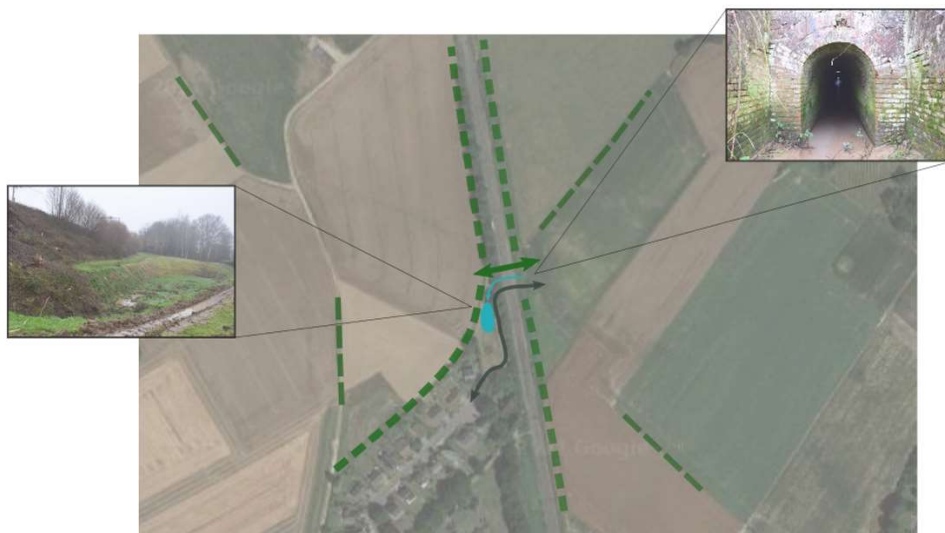
Figuur 75 3 verbindingen onder spoorweg thv Meikeverlaan (fiets- en voetgangerstunnel, overloop water en faunatunnel)
