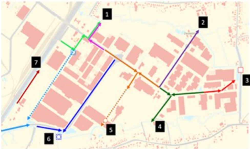
Figuur 1: Lozingspunten van hemelwater uit het Skaldenpark op de waterlopen (toestand januari 2021) (bron: studie van Opus 25 in opdracht van NSP)
