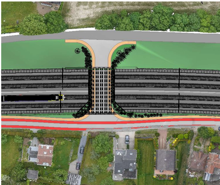
Figuur 4: Verhuizing brug Kleiveld en verbindingen voor fauna. Bron: TUC RAIL
