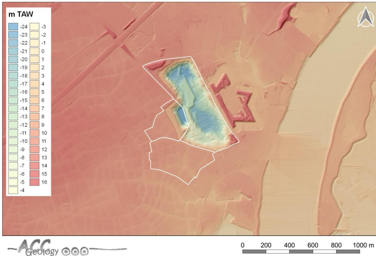
Figuur 12 Uittreksel van het digitaal terreinmodel (DTM-II 1m) met combinatie van een kleurencode voor de hoogte en een schaduwbeeld voor de reliëfdetails. Naast de grote hoogte verschillen tussen fort en groeve, zijn ook de bolle akkers in de ruimere omgeving goed zichtbaar
