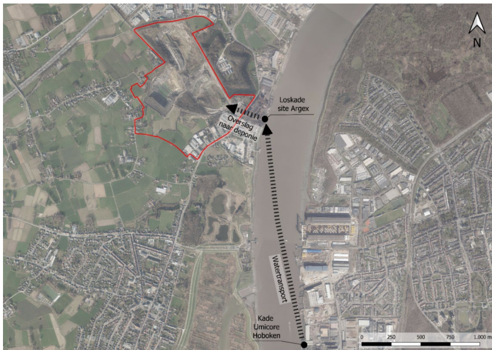
Schematische weergave van aanleverroute materiaal tussen site Umicore Hoboken en kleigroeve Argex
