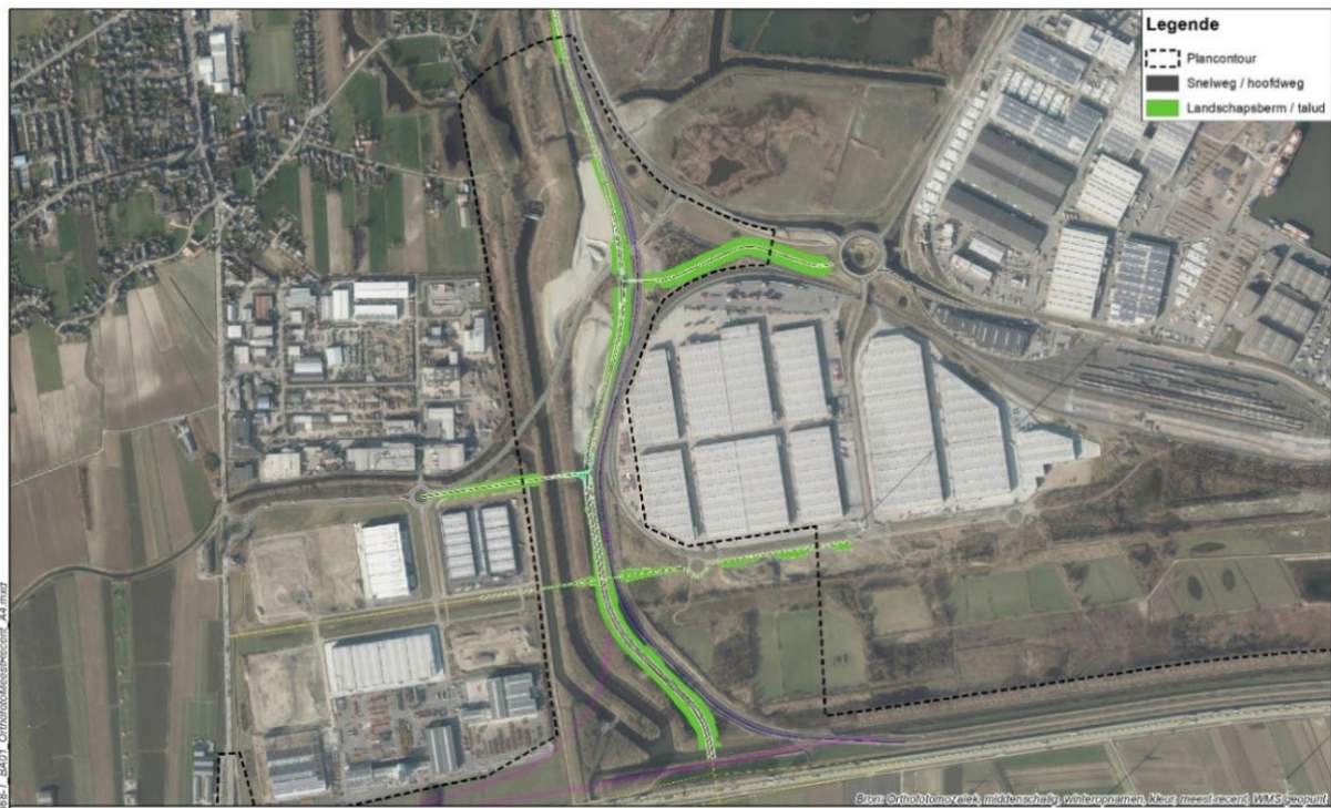
Figuur 11 Het voorkeursalternatief: complex Watermolen als twee T-kruispunten – Het oostelijk niet gebruikte deel van de Schoorhavenweg wordt opgebroken.
