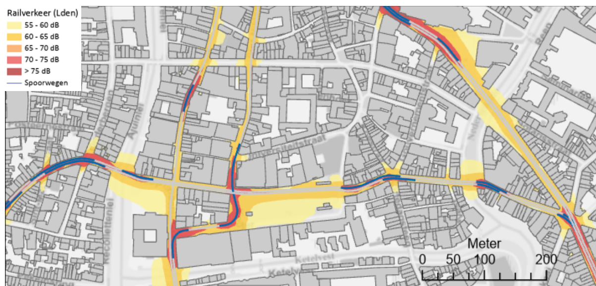
figuur 54 Voorbeeldgrid 10x10m voor trams (blauwe lijn geeft aan of er een booggeluid-correctie van toepassing is)
