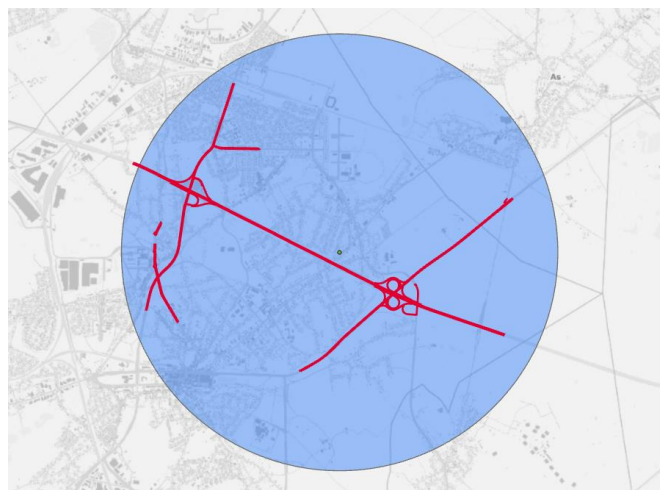
figuur 34 Voorbeeld van een zoekafstand van 3500 meter. Alle bronnen in de cirkel worden gebruikt voor de bepaling van de geluidsbelasting
