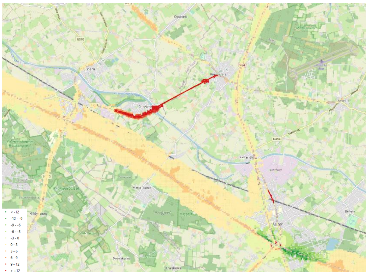
figuur 84 Detail heatmap wegverkeer met verschillen in geluidsbelastingen ( L_{den} ) op rasterpunten tussen 4 e ronde en 3 e ronde geluidskartering – omgeving Sint-Joris / Aalter
