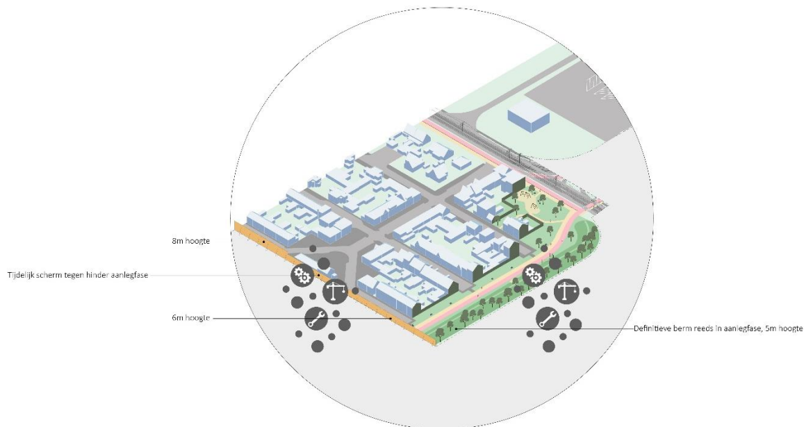
Figuur 3-10. Schematische weergave van de voorzienene bufferberm en schermen ter hoogte van de Stationswijk (leefbaarheidsmaatregelen)
