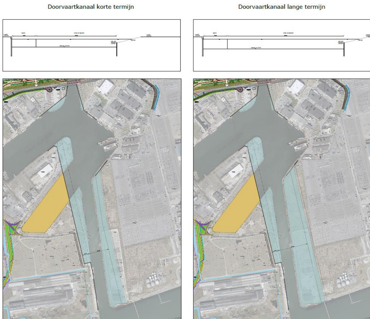
Figuur 2-12 : Verbreding en verdieping Doovartkanaal volgens eerste fase (links) en een latere fase (vermoedelijk 2045-2048) (rechts)
