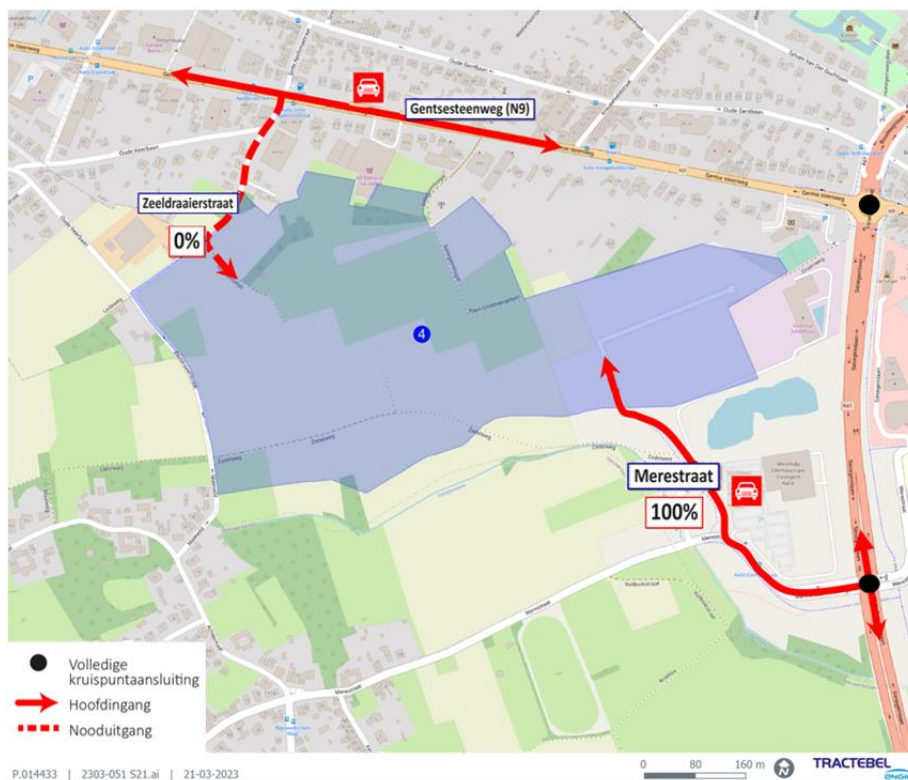
Figuur 3-8: Verdeling in- en uitgaande stromen Siesegemkouter Noord (bron: MOBER LFPC Aalst, juli 2023, Tractebel)
