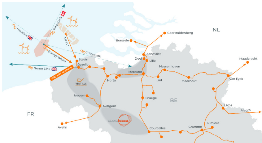
Figuur 5: principe van 'vermazing' binnen het elektriciteitsnet
