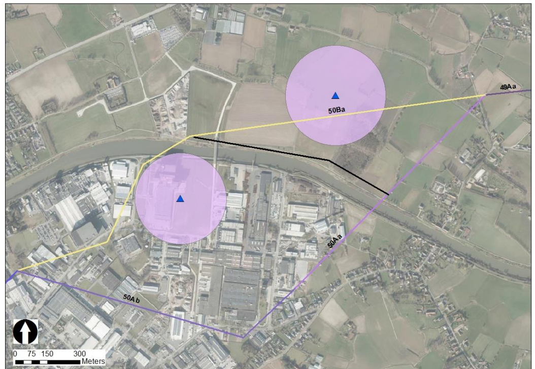
Figuur 2-39: zwart: mogelijke tracéwijziging ter hoogte van 50Ba, paars: 1,5x de rotordiameter rondom vergunde windturbines
