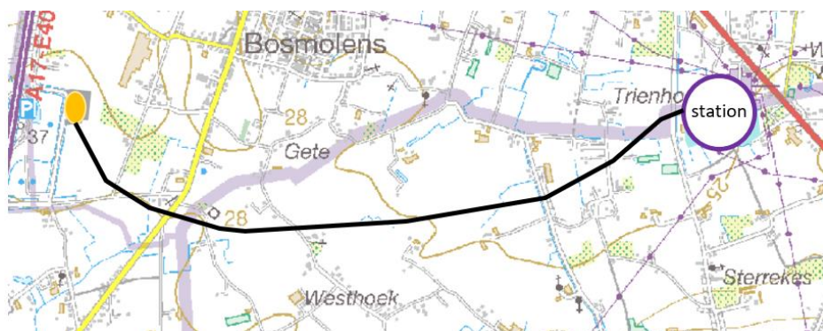
figuur 5-14: Schematische voorstelling bovengronds tracédeel Roeselare – Izegem, met aanduiding opstijgpunt Izegem-zuid (geel) en hoogspanningsstation Izegem (paarse contour)
