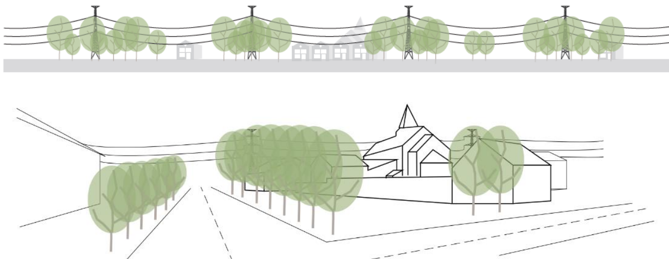
figuur 5-11: Schematische voorstelling visuele en landschappelijke inpassing van een hoogspanningsverbinding / bomen aanplanten op welgekozen locaties
