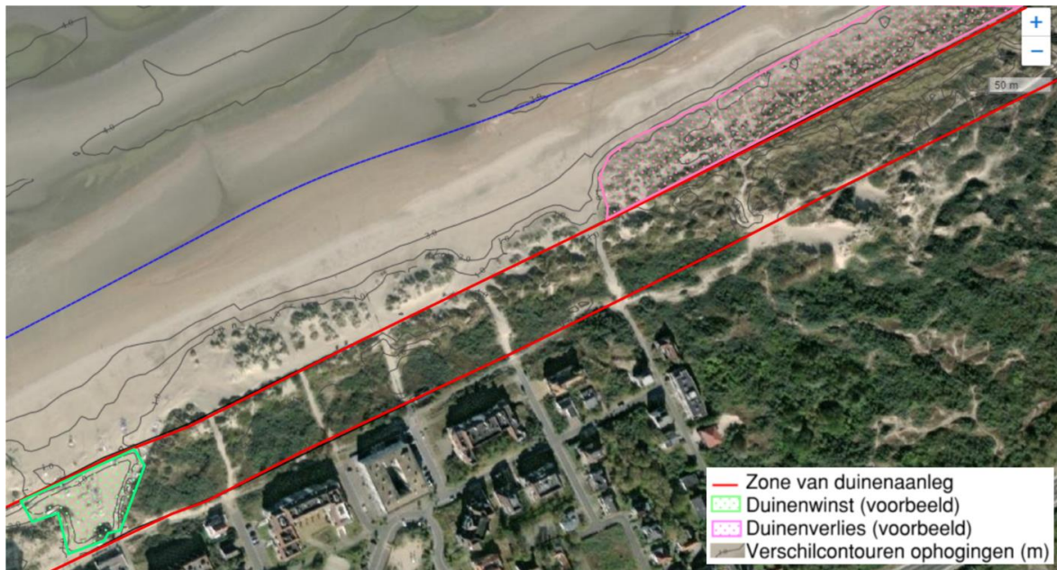
Figuur 5-1 Aannames duinenwinst en -verlies in GIS-analyse (blauwe lijn = hoogwaterlijn voor alternatief S)
