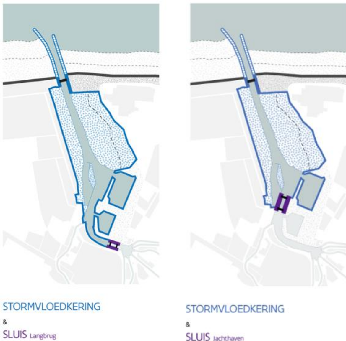
Figuur 5-15: Voorgestelde alternatieven voor de haven van Nieuwpoort.
