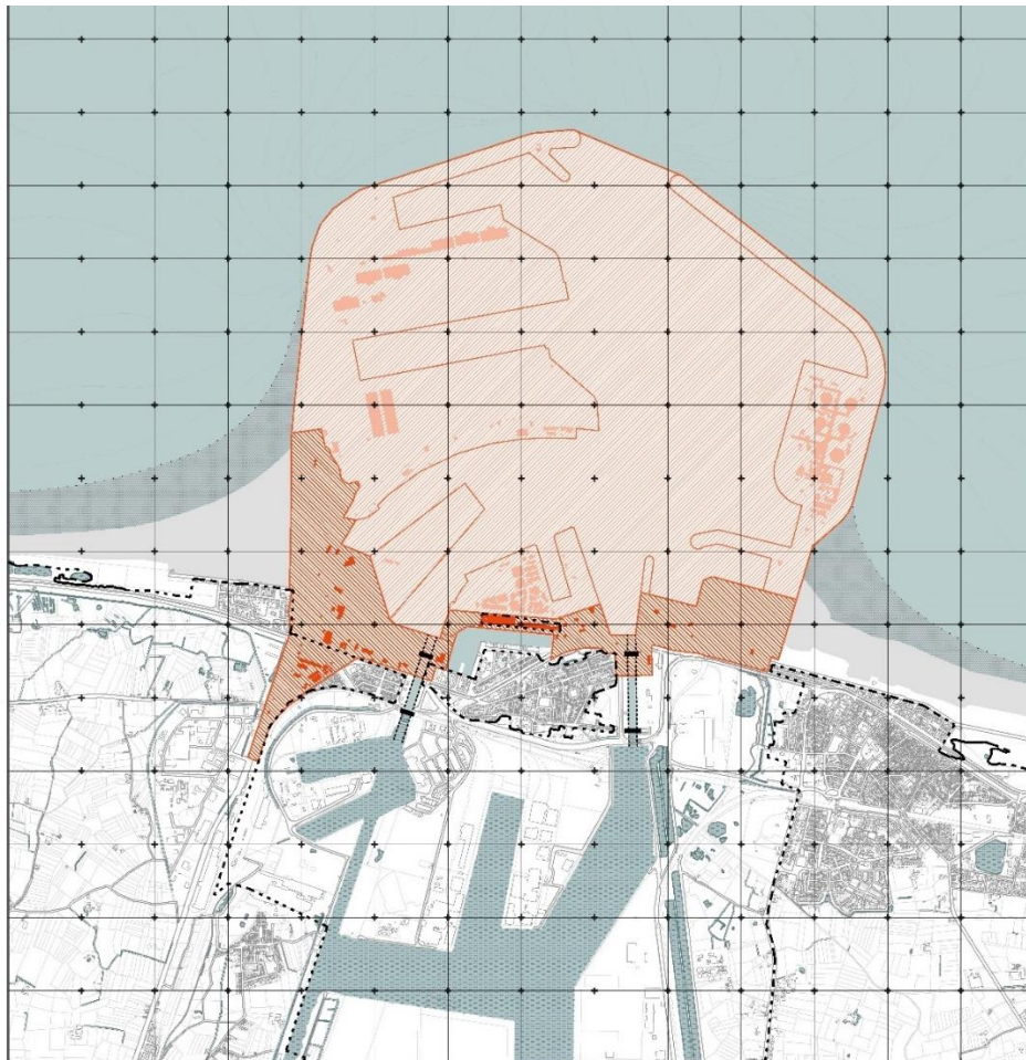
Figuur 16-10: Beschermingslint van het redelijk alternatief in de haven van Zeebrugge bij een open voorhaven en stormvloedkering bij de jachthaven met sprong naar open sluis. Het lichtoranje lint toont de zone in de voorhaven met behoud van het huidige beschermingsniveau (lager dan de 1000-jarige storm). De donkeroranje zone toont het beschermingslint nodig voor de bescherming van het achterland tegen de 1000-jarige storm, met flexibele zeevaartse afbakening (de rode stippellijn)
