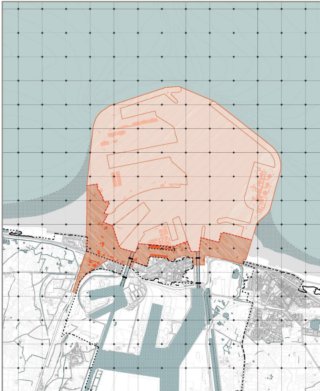
Figuur -5-40: Beschermingslint (de oranje gearceerde zone) van het alternatief met open voorhaven, stormvloedkering bij de jachthaven en met uitgestelde keuze voor de sprong naar stormvloedkering , sluis of open sluis na +2m zeespiegelstijging.
