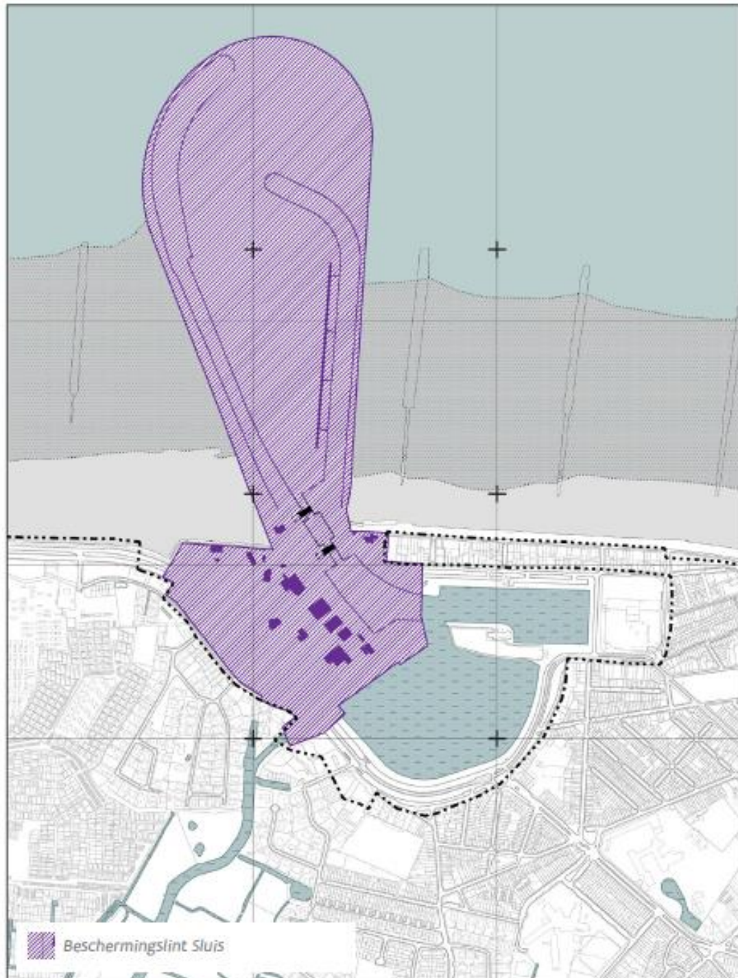
Figuur 5-29: Beschermlingslint (de paars gearceerde zone) van het redelijk alternatief in de haven van Blankenberge bij een bescherming met stormvloedkering met sprong naar open sluis na +2m zeespiegelstijging.
