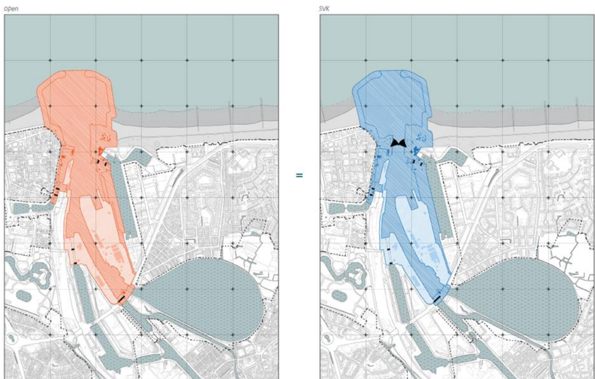
Figuur 5-21: Beschermingslint van het redelijk alternatief in de haven van Oostende bij een bescherming open havenmond (linkse figuur, oranje gearceerde zone) met een sprong naar stormvloedkering na +1 m zeespiegelstijging (rechtse figuur, blauw gearceerde zone)
