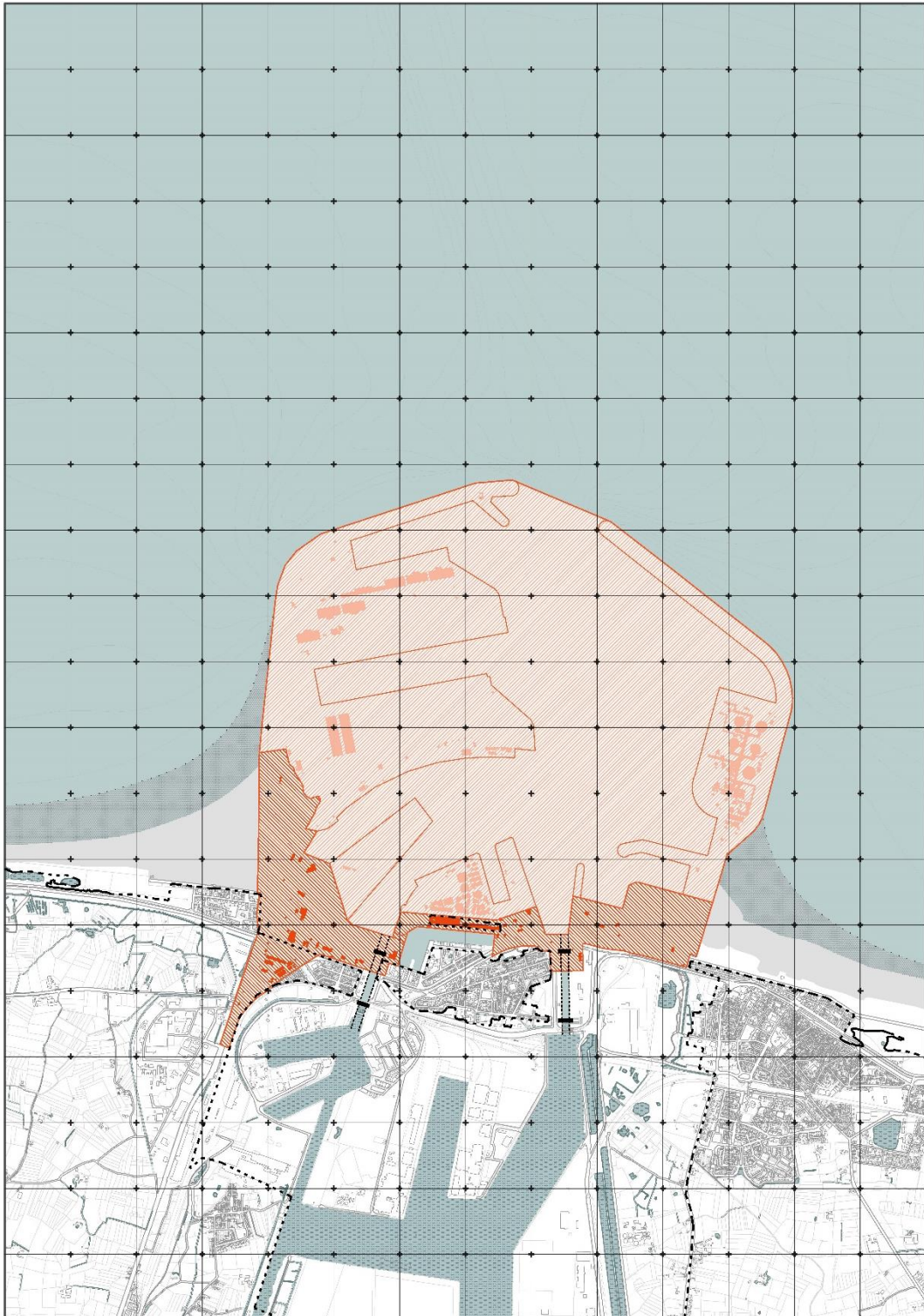
Figuur 5-37: Beschermingslint (de oranje gearceerde zone) van het redelijk alternatief in de haven van Zeebrugge bij een open voorhaven en stormvloedkering bij de jachthaven met sprong naar open sluis.
