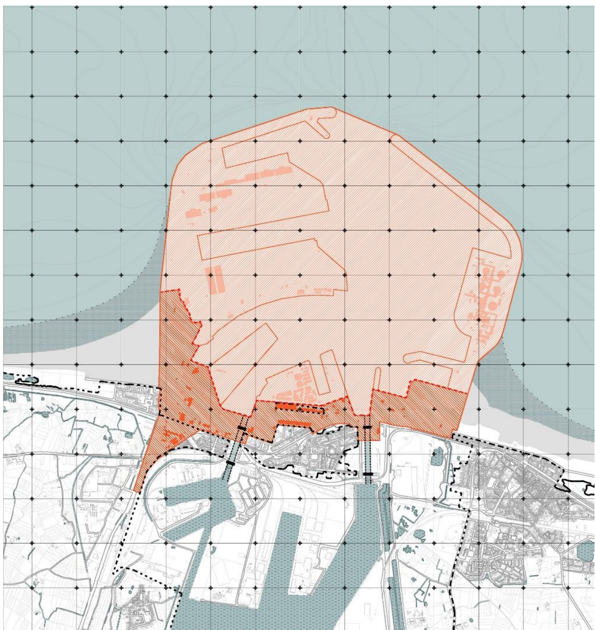
Figuur 14-12: Beschermingslint van het redelijk alternatief in de haven van Zeebrugge bij een met open voorhaven en open jachthaven. Het lichtoranje lint toont de zone in de voorhaven met behoud van het huidig beschermingsniveau (lager dan de 1000 jarige storm). De donker oranje zone toont het beschermingslint nodig voor de bescherming van het achterland tegen de 1000-jarige storm, met flexibele zeewaartse afbakening (de rode stippellijn)
