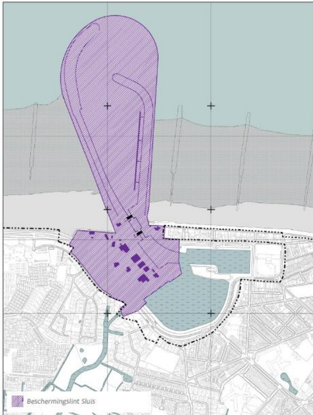
Figuur 5-28: Beschermlingslint (de paars gearceerde zone) van het redelijk alternatief in de haven van Blankenberge bij een bescherming met stormvloedkering met sprong naar sluis na +2m zeespiegelstijging.
