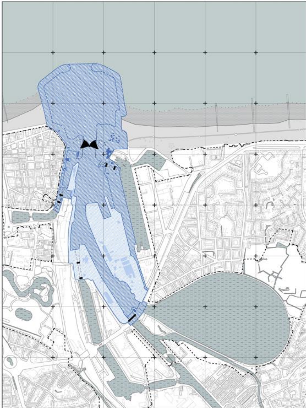
Figuur 16-6: Beschermingslint van het redelijk alternatief in de haven van Oostende bij een bescherming met stormvloedkering bij 3m zeespiegelstijging.
