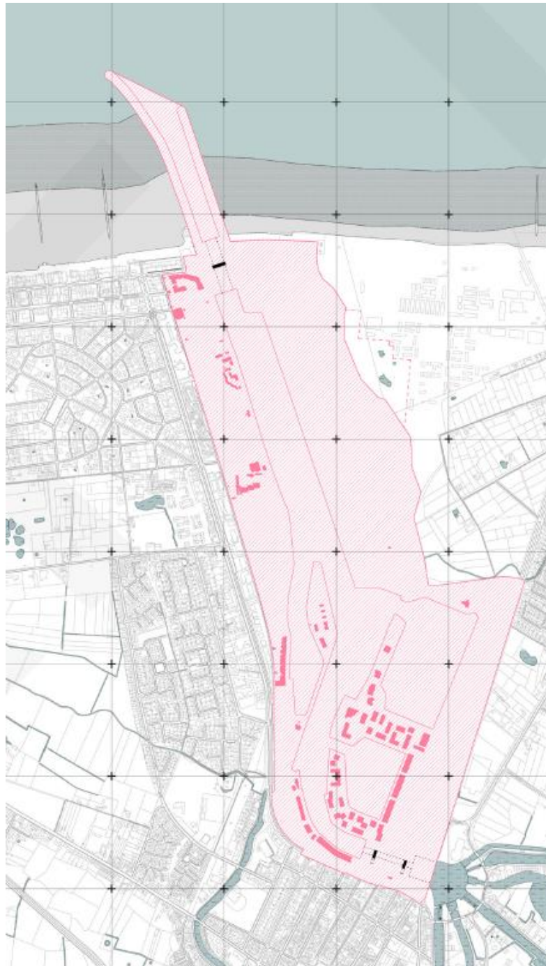
Figuur -4: Beschermingslint van het redelijk alternatief in de haven van Nieuwpoort bij een bescherming met stormvloedkering en een sluis ter hoogte van de Langbrug of bij de nieuwe jachthaven (gecombineerd alternatief) bij 3m zeespiegelstijging.
