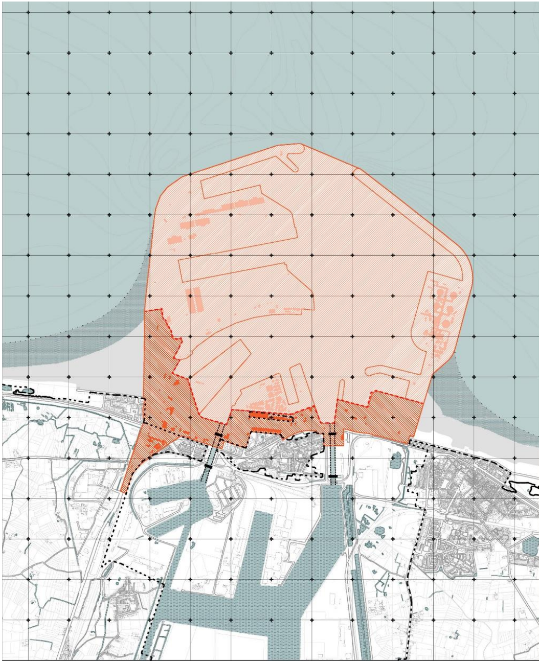
Figuur 5-36: Beschermingslint (de oranje gearceerde zone) van het redelijk alternatief in de haven van Zeebrugge bij een met open voorhaven en stormvloedkering bij de jachthaven (deel voorhaven)
