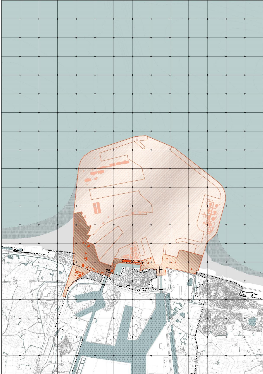
Figuur 5-38: Beschermingslint (de oranje gearceerde zone) van het redelijk alternatief in de haven van Zeebrugge bij een met open voorhaven en stormvloedkering bij de jachthaven met sprong naar een sluis .
