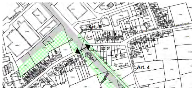
Figuur 109: Voorbeeld van een deel van een bestemmingsplan waarbij een symbolische aanduiding wordt gebruikt om een fietsverbinding aan te duiden op het plan.
