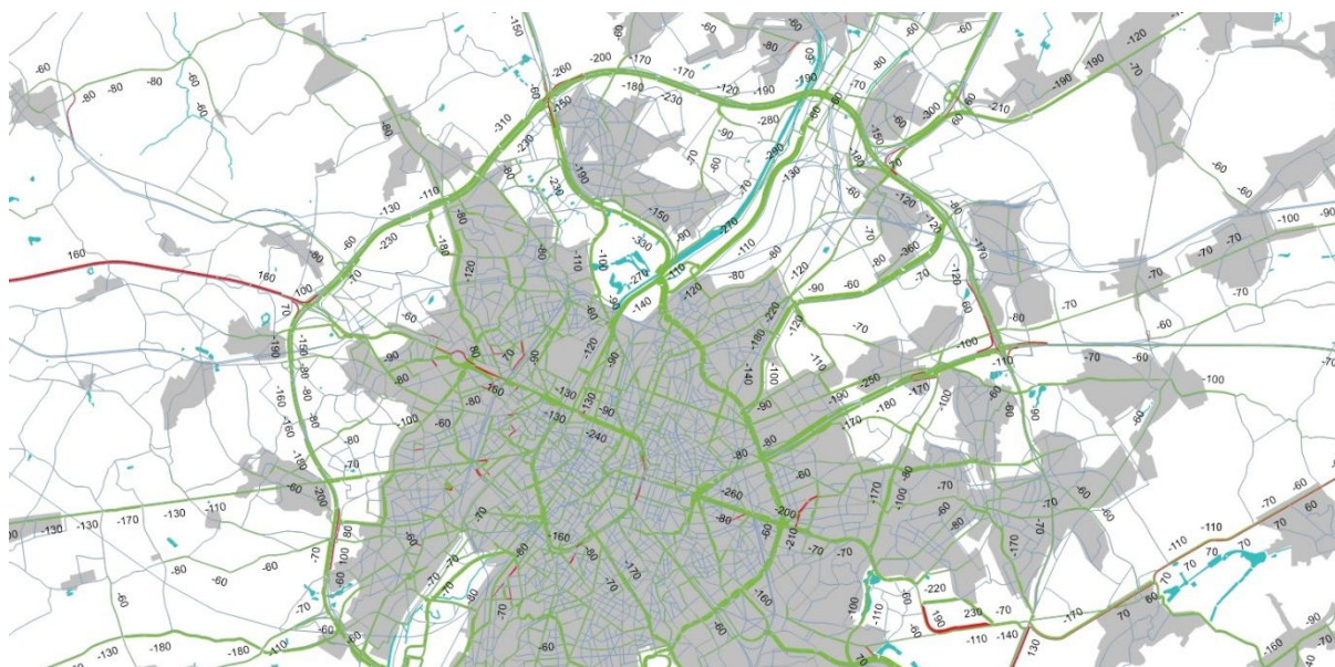
Figuur 5: Verschillenplot ochtendspits – combinatie 3a met AMS, vergeleken met combinatie 3a zonder AMS (bron: RVM RND v4.2.1)
