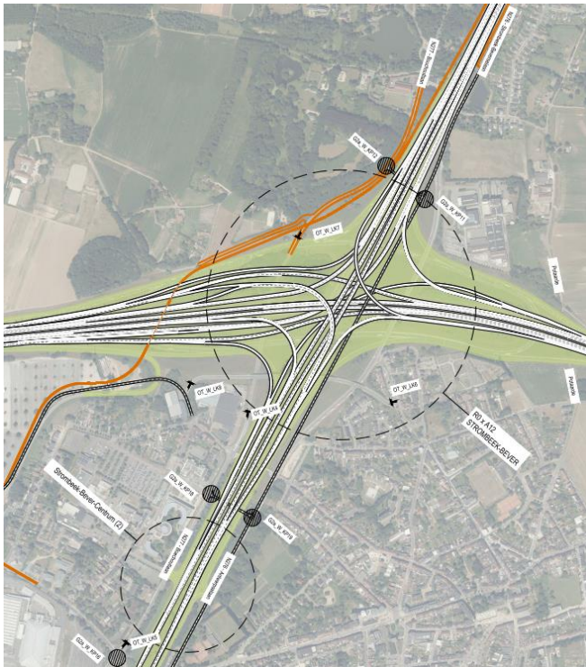
Figuur 65: VW A12 Strombeek-Bever variant a in G2 – Loop 2 → variant 4/4 knoop SRW en DRW
