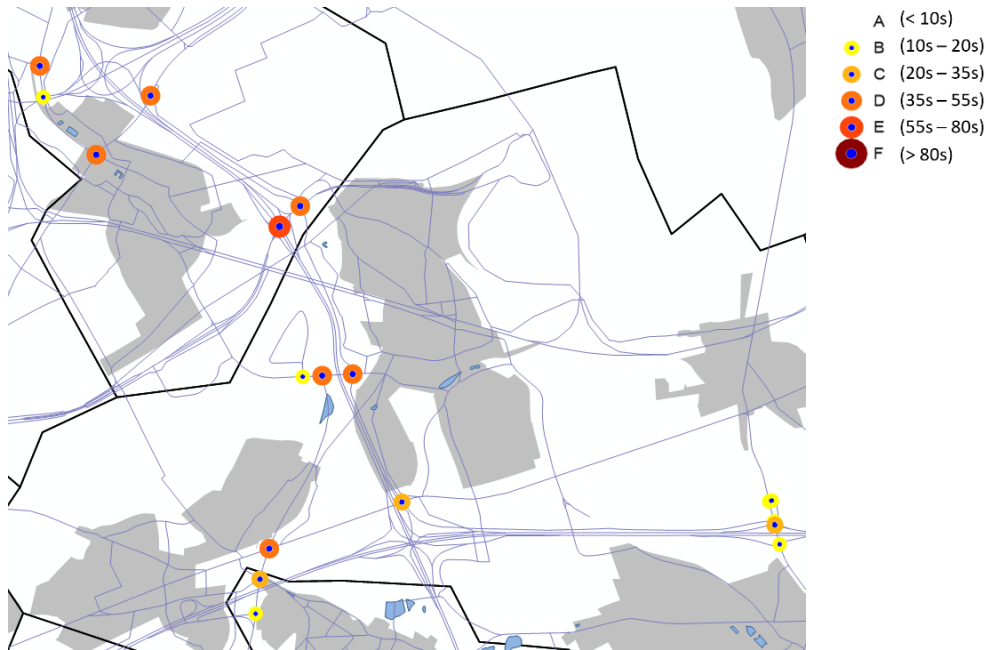
Figuur 55: LOS-analyse alternatief G3A1, zone Zaventem – OSP
