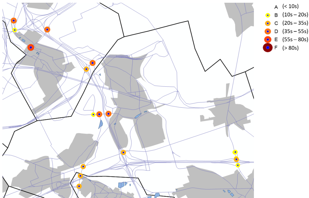
Figuur 73: LOS-analyse alternatief G3A3, zone Zaventem – OSP
