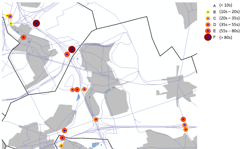
Figuur 56: LOS-analyse alternatief G3A1, zone Zaventem – ASP
