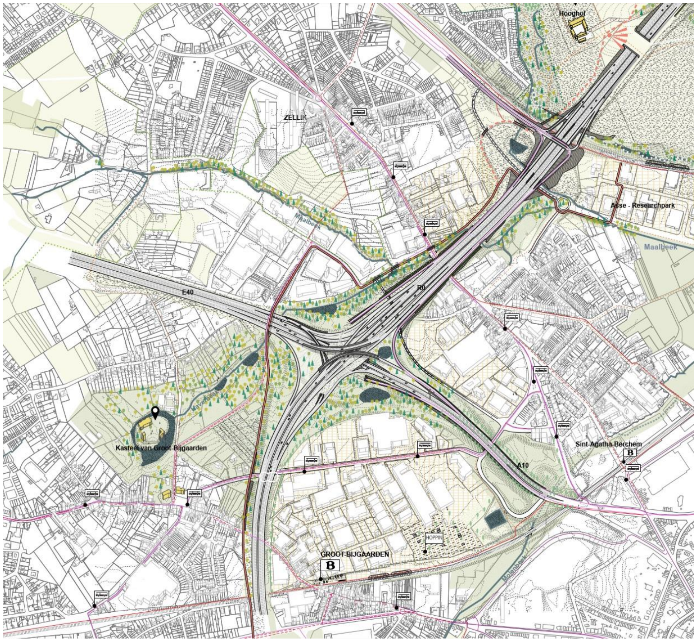
Figuur: Verkeerswisselaar R0xE40, vormgegeven als symmetrische 4/4 knoop en aansluitingscomplex 10, vormgegeven als asymmetrisch Hollands complex – indicatieve visualisatie van herinrichting R0-Noord en omgeving
