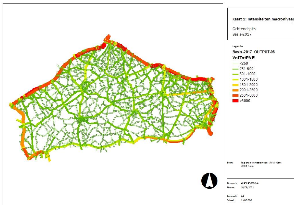
Figuur 4-8: Intensiteiten macroniveau: OSP: bestaande situatie
