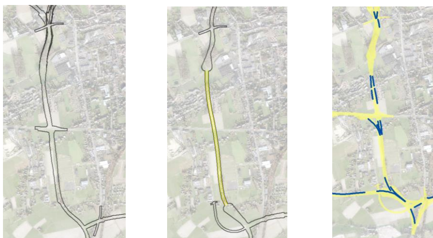
Figuur 6-23 Footprint alternatieven en te milderen effecten in deelzone Floreal-Rosco-Pontstraat
