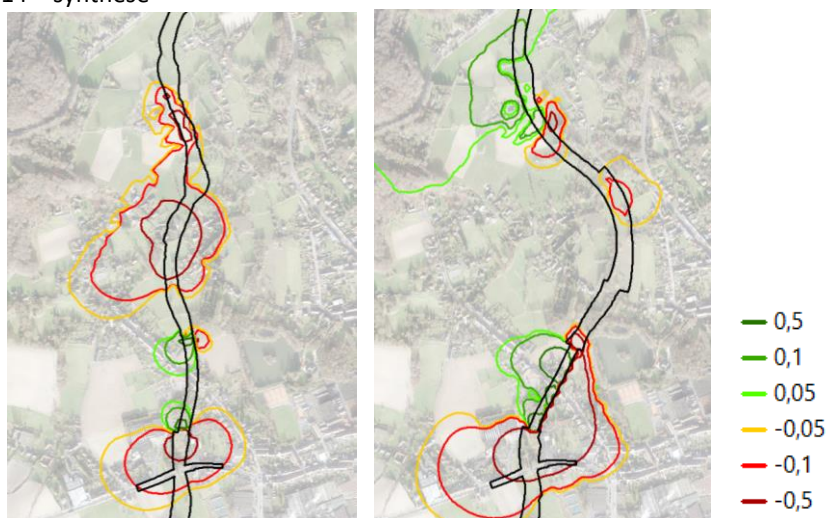
Figuur 14-38 Wijziging grondwaterstand bij alternatief I7 (links) vs I7plus (rechts)
