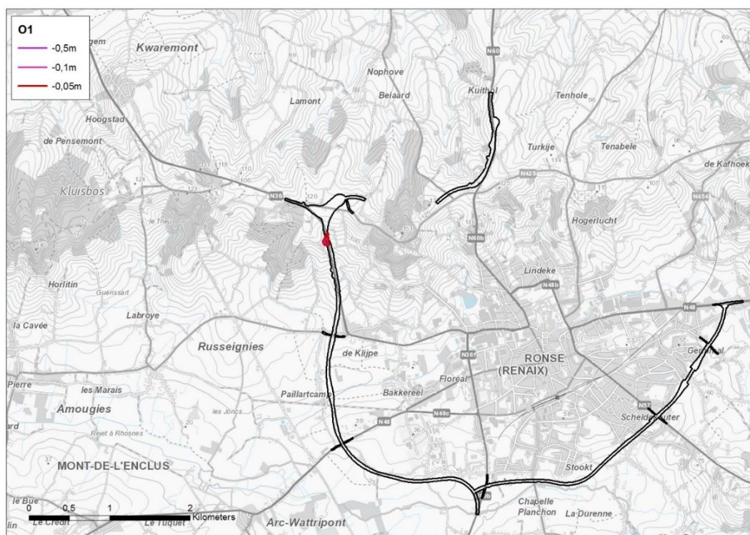
Figuur 10-31: grondwaterstandswijzigingen ten gevolge van tracéalternatief O1
