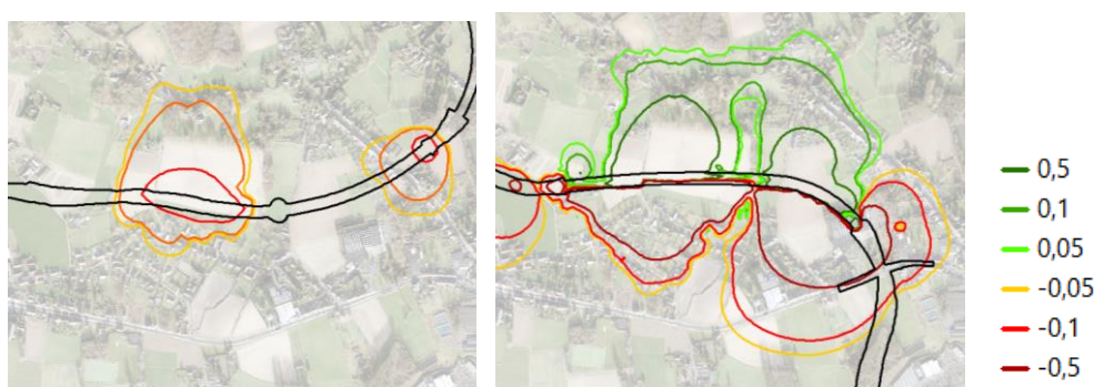
Figuur 14-39 Wijziging grondwaterstand bij alternatief I2 (links) vs C1 (rechts)
