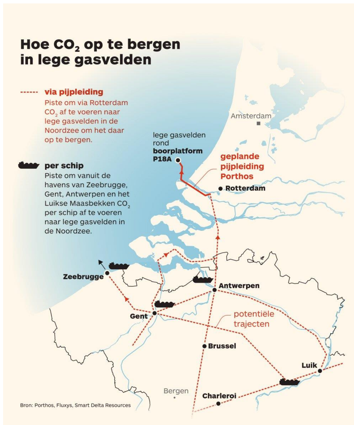
Figuur 42: Netwerk van pijpleidingen voor het afvangen en transporteren van CO 2 naar Nederland. 82
