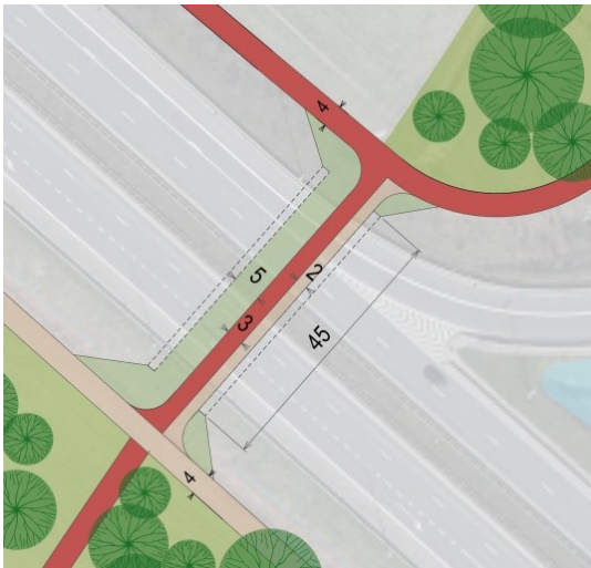
Figuur 23 detail ontwerp wandel-eco tunnel onder Luchthavenlaan
