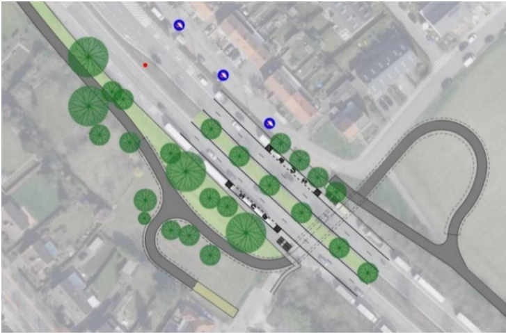
Figuur 160: schetsontwerp fietstunnel onder de Luchthavenlaan ter hoogte van de Heirbaan (bron wijzigingsdocument fietssnelweg F214, juni 2021 )
