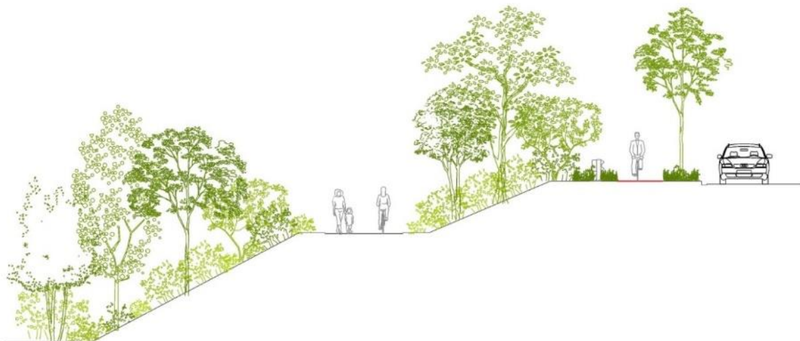
Figuur 142: dwarsprofiel wandelpad in berm Sint-Martinuslaan
