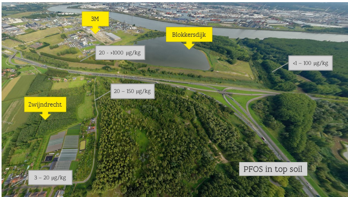
Figuur 10: luchtbeeld van 3M-Oosterweel site, toestand voor aanvang Oosterweelwerken, met aanduiding grootteorde PFOS-concentraties in toplaag; bronnen: Vlaamse overheid, ERM, Lantis
