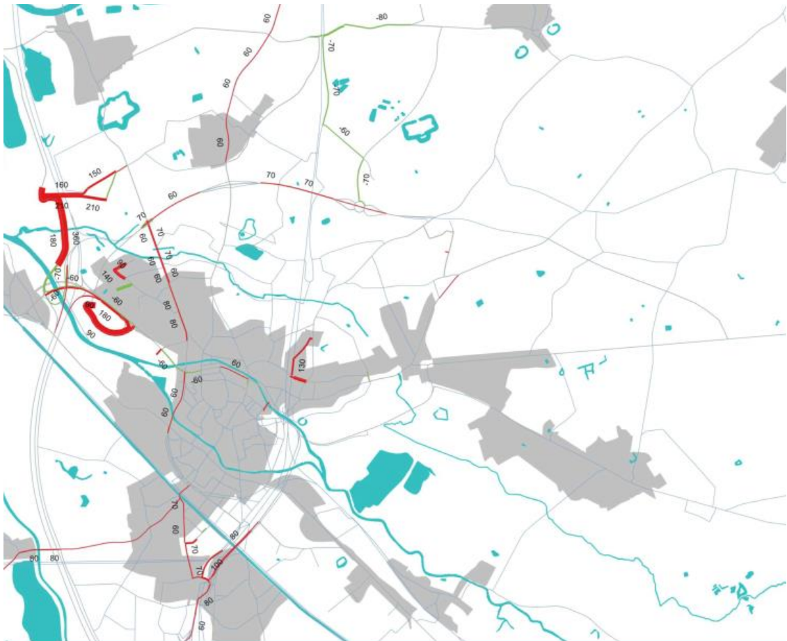
Figuur 6-48: Verschil tussen het referentiescenario 1 en de doorrekeningen met het nieuwe model (december 2021), voor de ochtendspits
