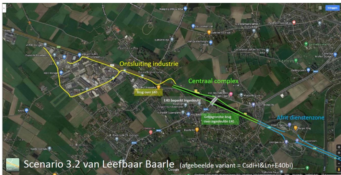
Figuur 3-4: Centraal complex met rondabout diamond interchange en noordelijke ontsluitingsweg bedrijventerrein en ingesleufde E40 – variant CsdI+I&Ln+E40bi
