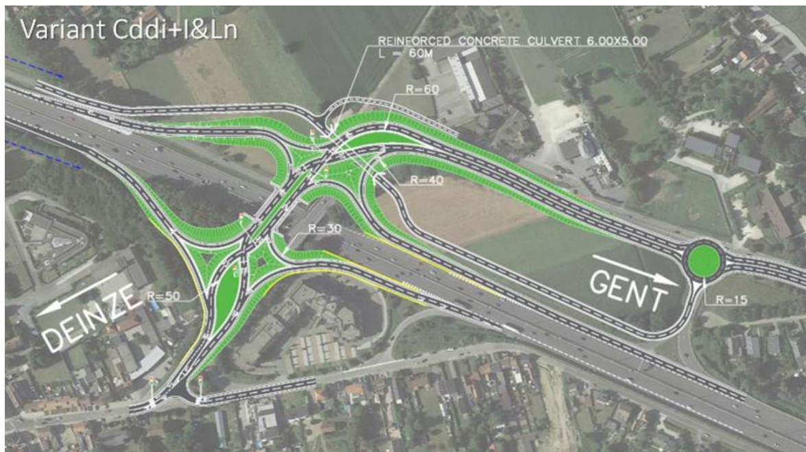
Figuur 2-7: Centraal complex met divergent diamond interchange met turborotonde en noordelijke ontsluitingsweg bedrijventerreinbedrijventerrein – variant Cddi+I&Ln
