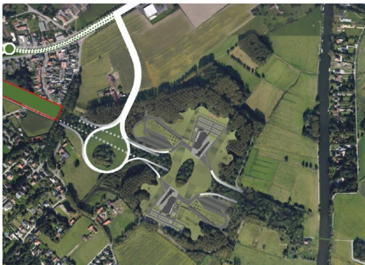
Figuur 3-18: Verzonken oostelijke op- en afrittencomplex met ingetunnelde E40
