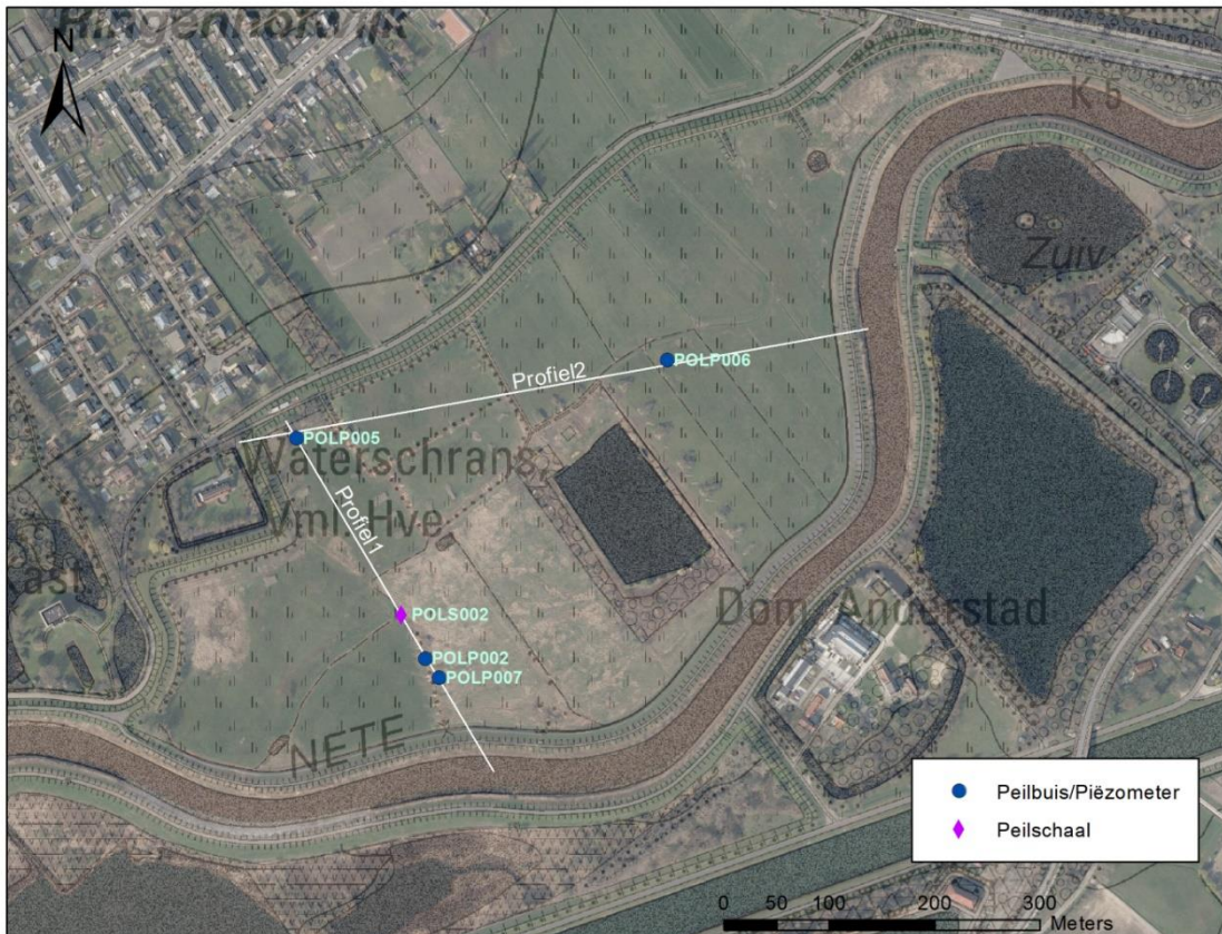
Figuur 4-12: Locatie van de meetpunten grond- en oppervlaktewaterdynamiek in de Polder van Lier
