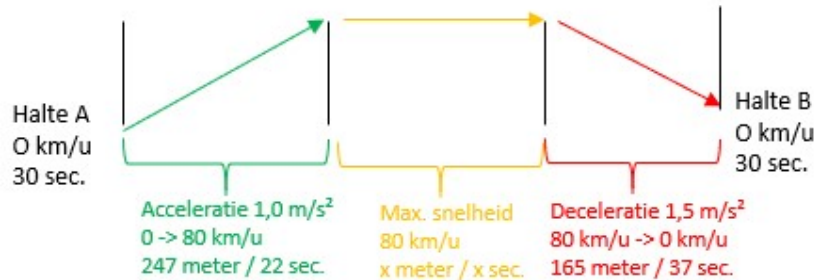
Figuur 7 – Berekeningswijze snelheid in free flow-zones (Input acceleratie en deceleratie De Lijn)
