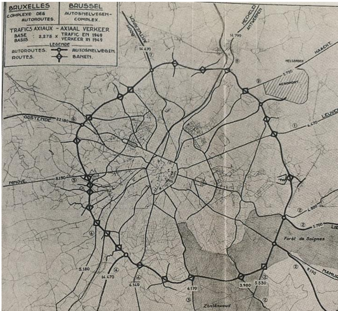
Figuur 38: Ontwerp van het autosnelwegennetwerk in België door Hondemarcq (1952)
